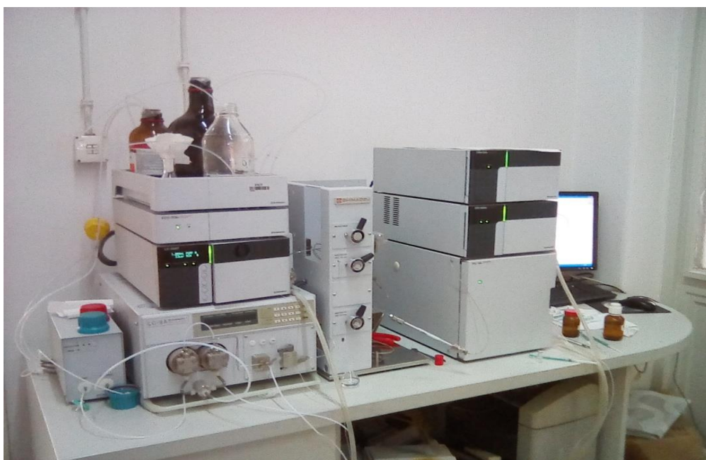
Slika 11. Uređaj za tekućinsku kromatografiju visoke djelotvornosti (HPLC) proizvođača Shimadzu.
