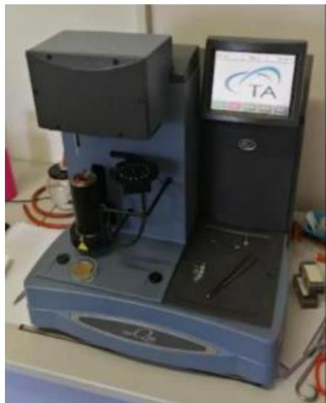
*Slika 21.* TA Instruments Q500 termogravimetar
