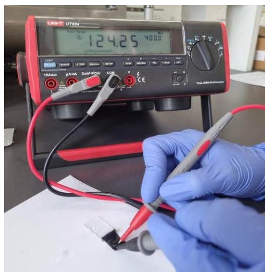
Slika 41. Mjerenje otpora PEDOT-Br:S-SEBS filma nakon ispitivanja stabilnost u otopini NaCl-a
