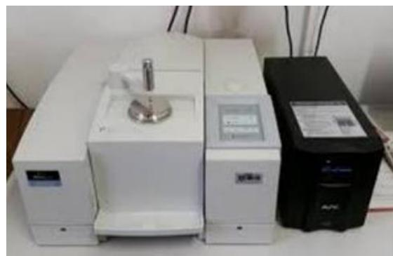
**Slika 19.** Perkin Elmer Spectrum One spektrometar
