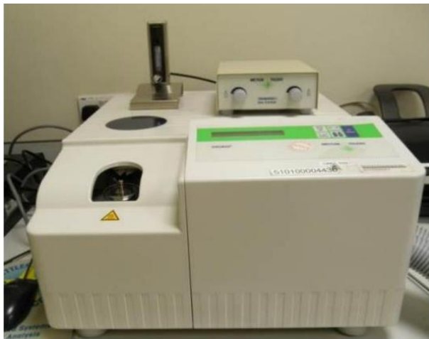
Slika 22. Mettler Toledo DSC 823eT kalorimetar
