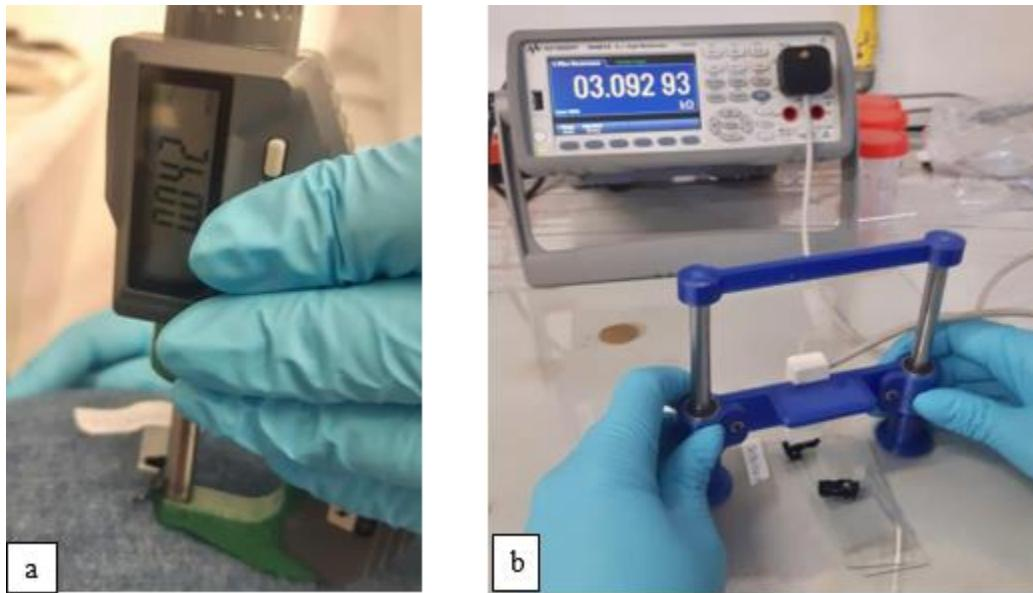
Slika 38. a) prikaz mjerjenja debljine filma, b) prikaz mjerjenja otpora filma
