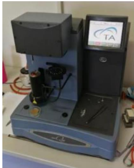
Slika 21. TA Instruments Q500 termogravimetar
