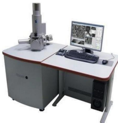
Slika 20. Pretražni elektronski mikroskop Tescan Vega 3
