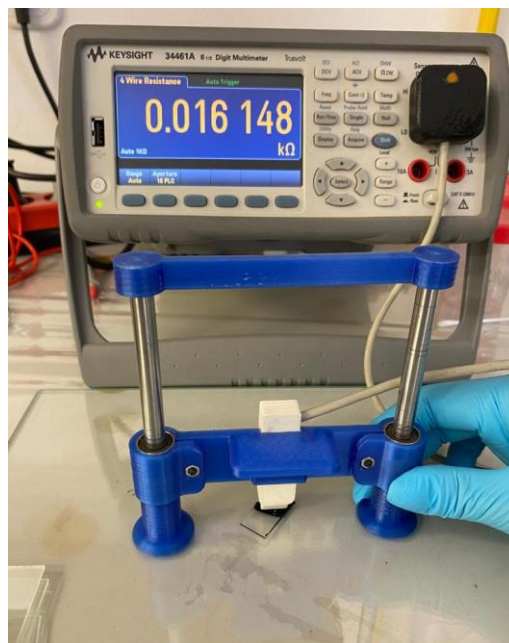
Slika 23. Keysight 34461 6 1/2 Digit multimeter
