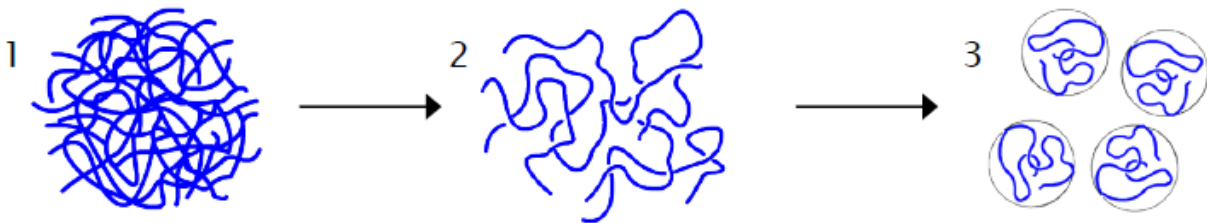
Slika 11 Shematski prikaz otapanja polimera [15]
