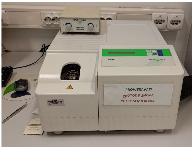
Slika 33 Uređaj Mettler Toledo DSC823e
