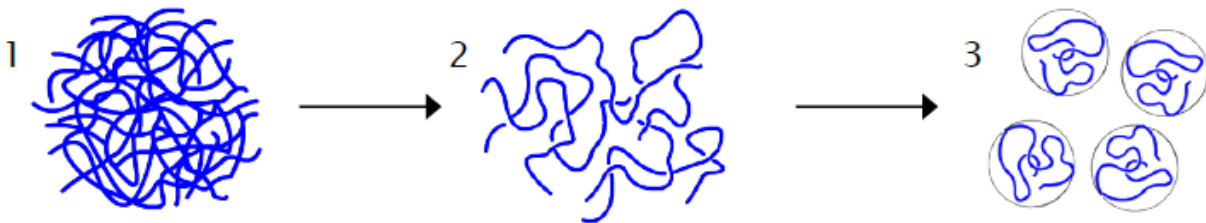
Slika 11 Shematski prikaz otapanja polimera [15]
