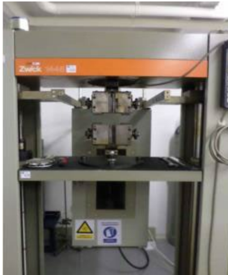
Slika 35 Kidalica UTM 1445 Zwick Röell
