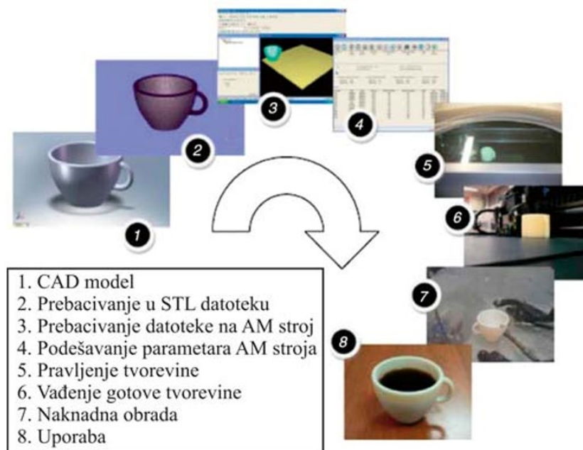
Slika 21 Faze općenitog postupka aditivne proizvodnje [43].
