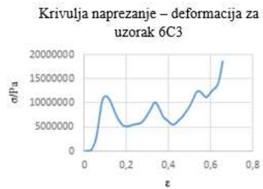
Slika B28. Krivulja naprezanje - deformacija za uzorak C u šestom tjednu razgradnje.
