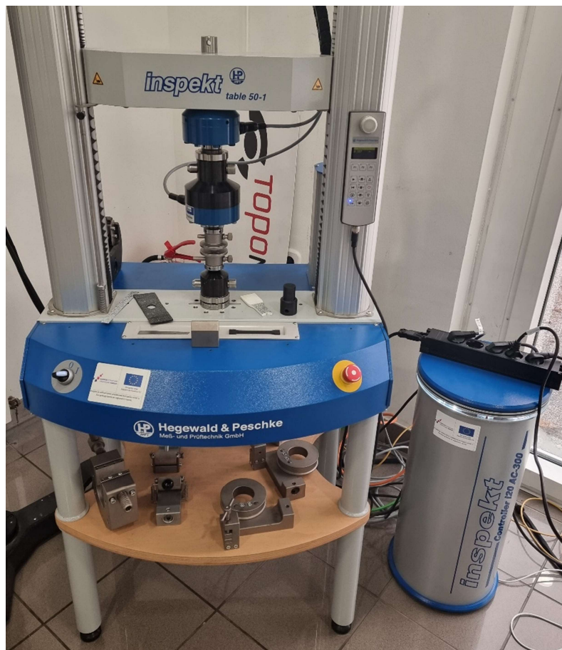
Slika 19. Hegewald & Peschke uređaj korišten za određivanje tlačne čvrstoće i modula elastičnosti.
