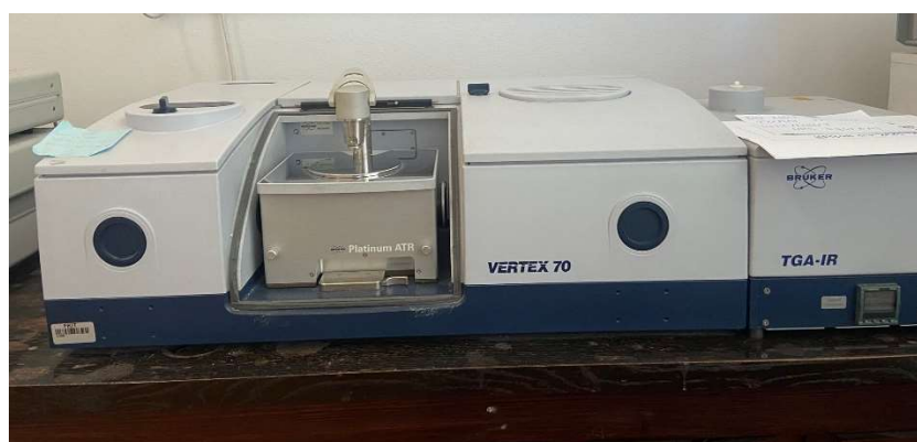
Slika 17. Spektrometar Bruker Vertex 70.
