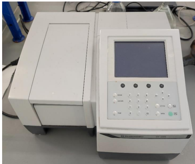
Slika 8. Fotografija spektrofotometra UV-1280 (Shimadzu, Kyoto, Japan)
