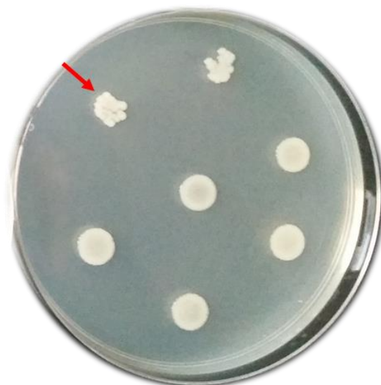
Slika 45. Hranjivi agar s inokuliranih 0,01 \text{ cm}^3 suspenzije bakterija koja je bila 24 h pri 37 \text{ }^\circ\text{C} u kontaktu s različitim masenim koncentracijama pjenostakla. Prema intenzitetu porasta bakterijskih kolonija u odnosu na pozitivnu kontrolu bez pjenostakla (u sredini) određena je vrijednosti minimalne inhibitorne koncentracije (MIK); Strelicom označena vrijednost MIK pri masenoj koncentraciji od 50 \text{ g/dm}^3 za uzorak SP2C23 (sastav prema tablici 10).
