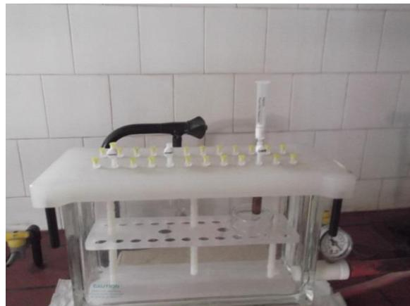
**Slika 39.** Višekolonski vakuumski SPE ekstraktor
