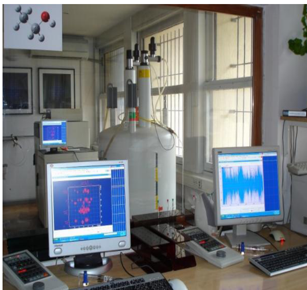
Slika 3.6. Fotografija NMR-spektrometra [114] i shematski prikaz rada NMR-spektrometra [115]
