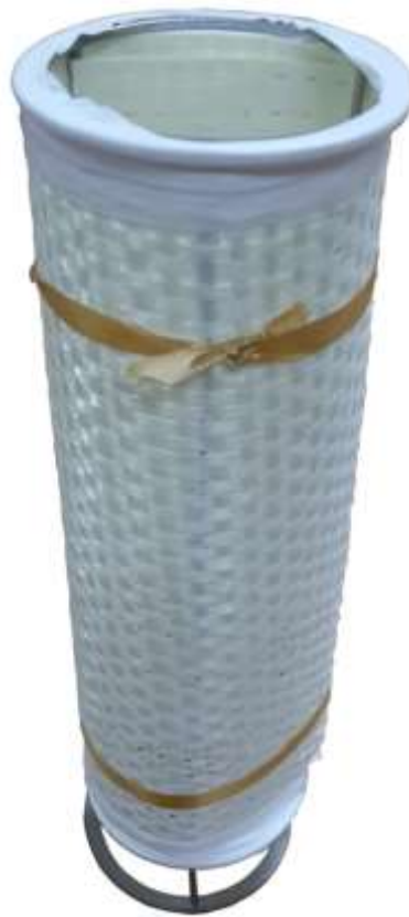
Slika 3.2. Modul sa slojem fotokatalizatora ( \text{TiO}_2 /kitozan) impregniranim na staklenom platnu i učvršćenim na nosač izrađen iz inoksa.
