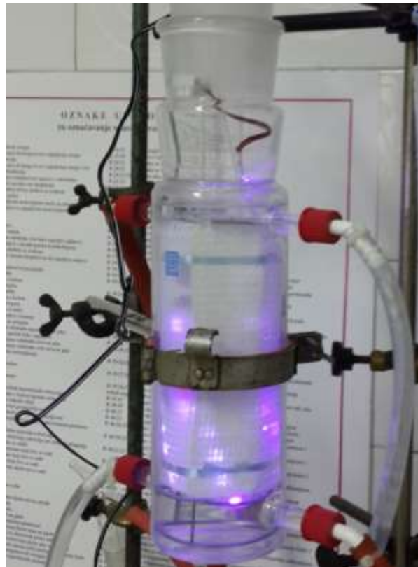
Slika 4.64. Fotokatalitički reaktor s UV LED trakom smještenom neposredno uz fotokatalitički sloj
