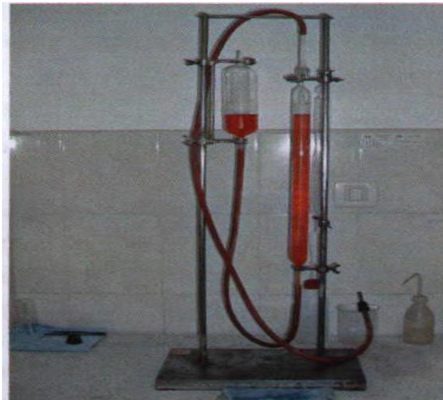
Slika 23 : Aparatura za određivanje CO 2 – kalcimetar
