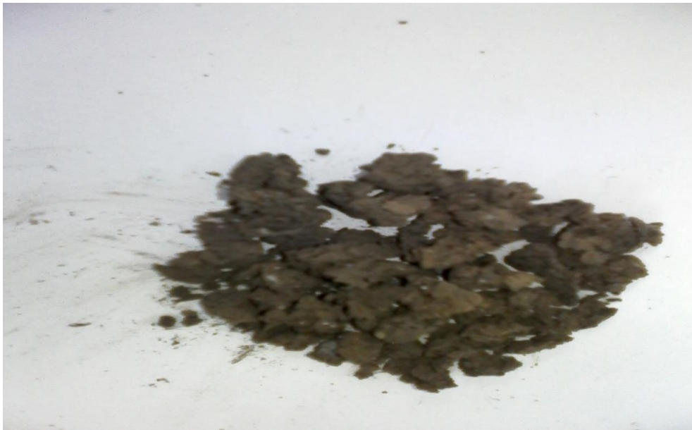
Slika 47: Prikaz dehidriranog mulja izloženog temperaturi od 500 °C
