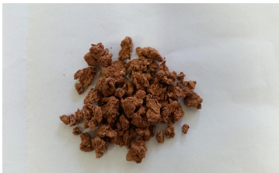
Slika 50: Prikaz dehidriranog mulja izloženog temperaturi od 1050°C
