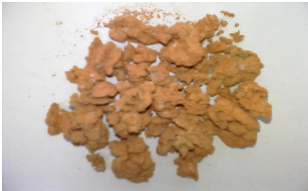
Slika 49: Prikaz dehidriranog mulja izloženog temperaturi od 900 °C
