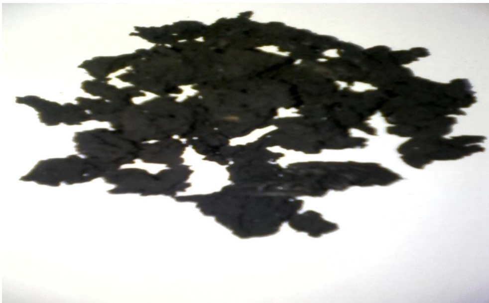
Slika 46: Prikaz dehidriranog mulja izloženog temperaturi od 300°C
