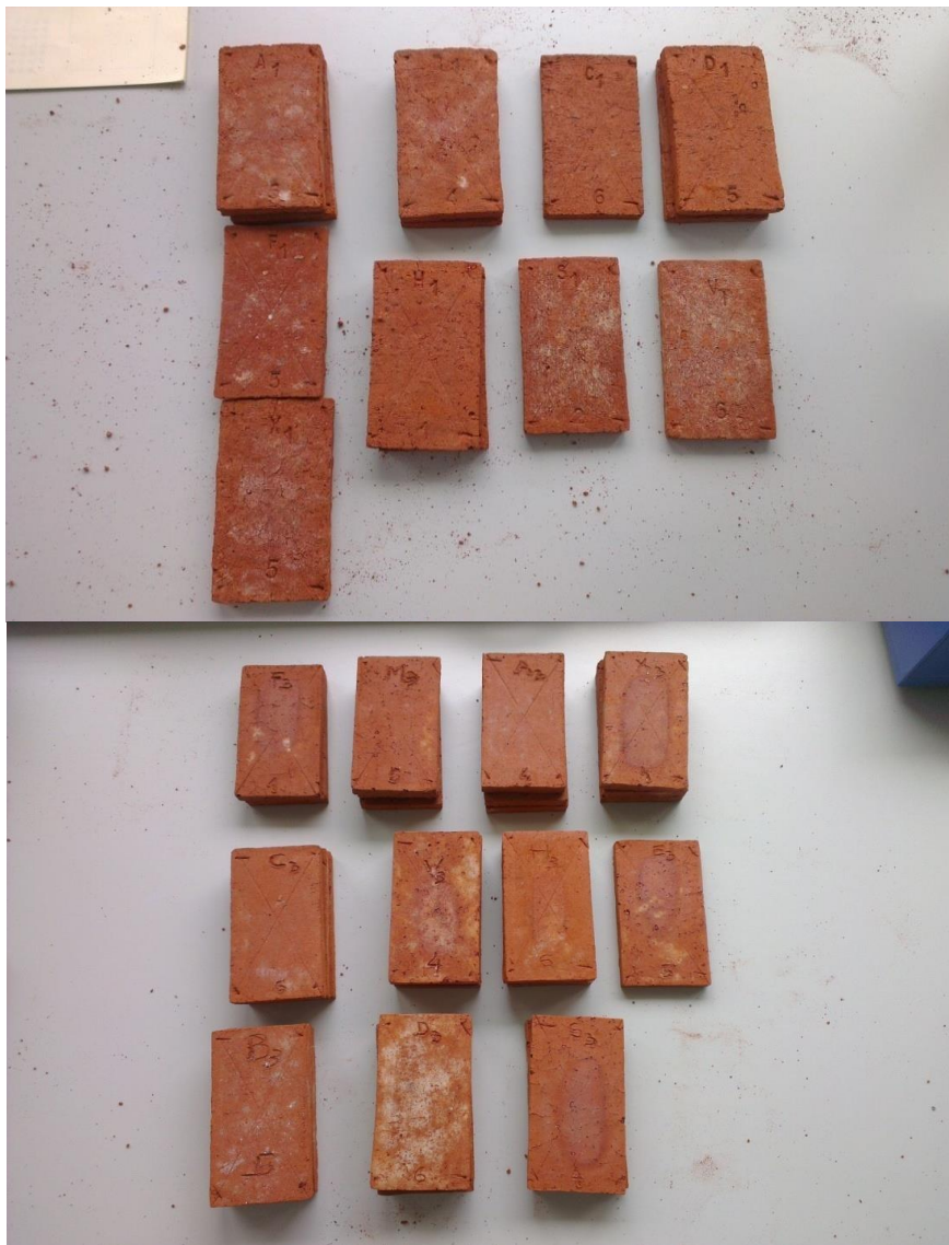
Slika 53: Prikaz ispečenih kompozitnih opeka serije I i II prema eksperimentalnom dizajnu.
