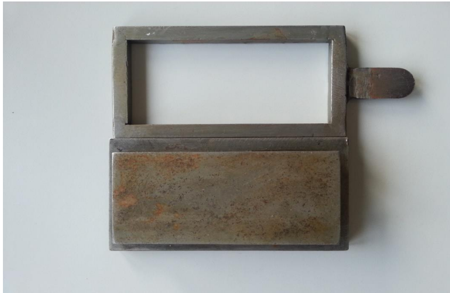
Slika 27 : Kalup za izradu kompozitnih opeka
