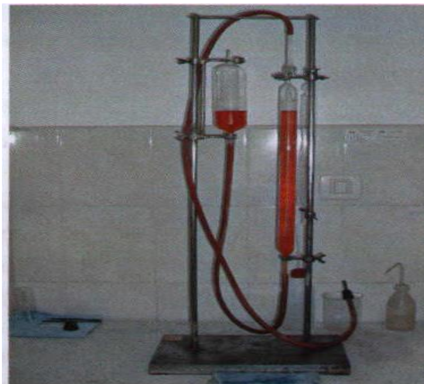
Slika 23 : Aparatura za određivanje CO 2 – kalcimetar
