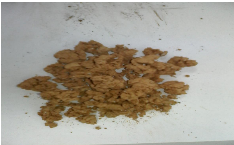
Slika 48: Prikaz dehidriranog mulja izloženog temperaturi od 700 °C
