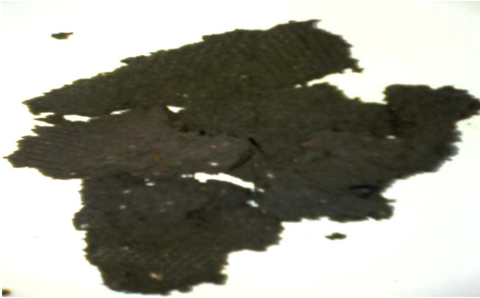
Slika 45: Prikaz sirovog dehidriranog mulja ( tzv. kolača )
