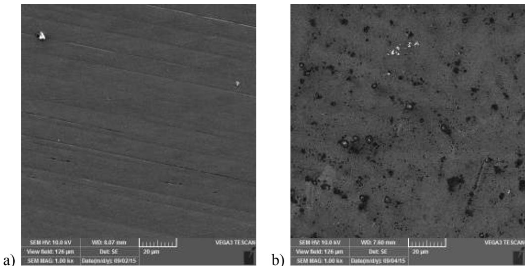
Slika 4.68. OK 0,001 M povecanje 1000x, a) prije i b) nakon izlaganja NaCl-u
