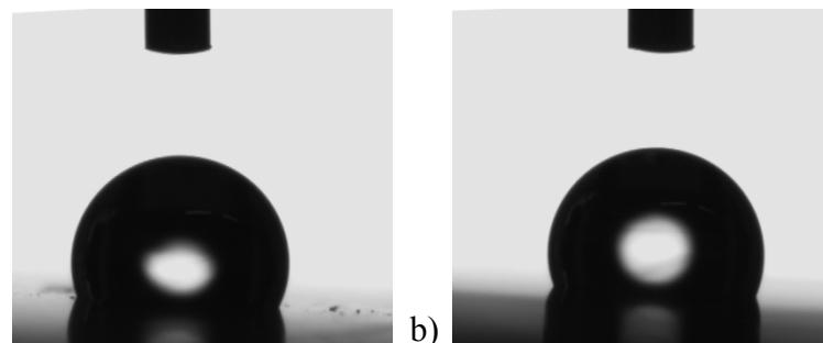
Slika 4.80. Kontaktni kut a) ODPA 0,001 M i b) HDPA 0,001 M
