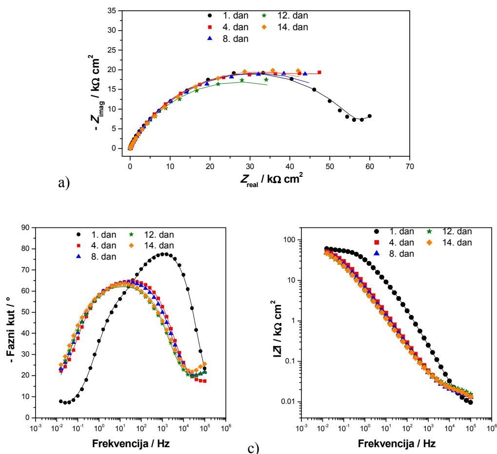
Slika 4.25. Impedancijske krivulje za uzorak K, a) Nyquistov prikaz, b) i c) Bodeov prikaz (simboli – eksperimentalni podaci, linije – rezultati dobiveni iz modela)
