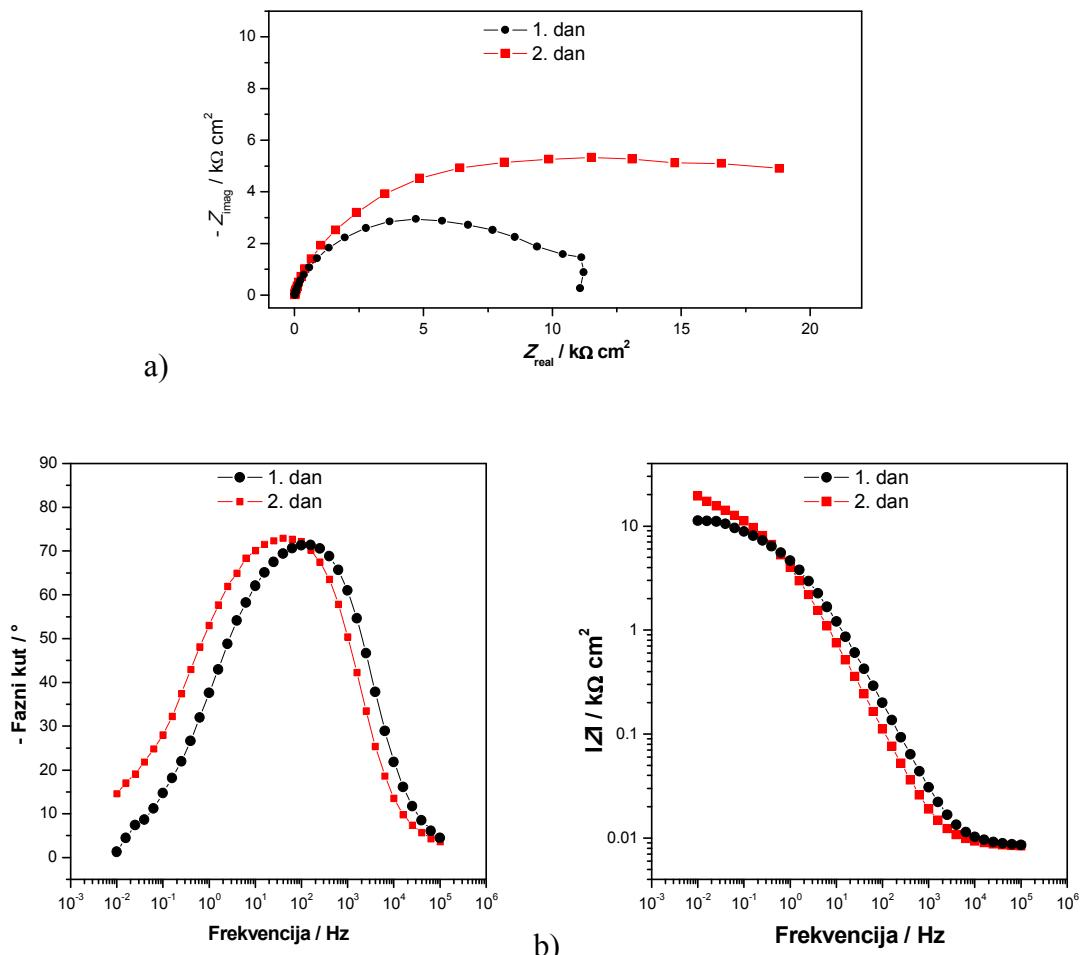
Slika 4.79. Impedancijske krivulje za uzorak tretiran s HFPA 0,005 M, a) Nyquistov prikaz, b) i c) Bodeov prikaz
