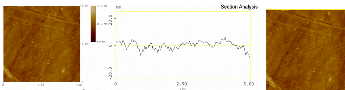
Slika 4.92. AFM slika uzorka tretiranog OK 0,001 M nakon brisanja etanolom
