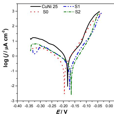
Slika 4.1. Polarizacijske krivulje dobivene ispitivanjem utjecaja faze sušenja
