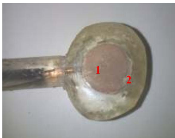
Slika 4.95. Netretirani CuNi 25 uzorak nakon izlaganja 43 dana prirodnoj morskoj vodi, 1 – srednji dio uzorka, 2 – rubni dio uzorka
