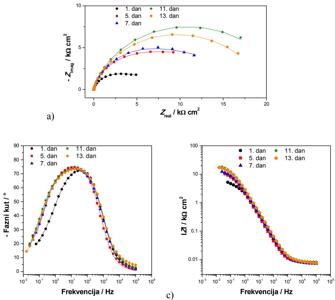
Slika 4.12. Impedancijske krivulje za netretirani uzorak CuNi 80, a) Nyquistov prikaz, b) i c) Bodeov prikaz (simboli – eksperimentalni podaci, linije – rezultati dobiveni iz modela)
