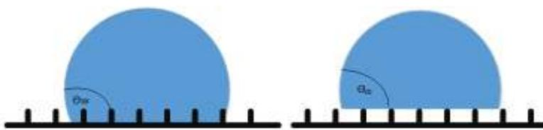
Slika 3.21. a) Wenzelov, b) Cassie – Baxterov kontaktni kut za neravnu, nehomogenu površinu<sup>98</sup>
