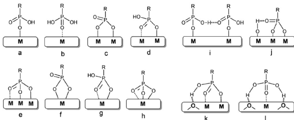
*Slika 2.11.* Načini vezanja fosfonskih kiselina na površinu oksida metala a) i b) monodentatni način vezanja, c) i d) bidentatni način vezanja, e) tridentatni način vezanja, f) i g) bidentatni način vezanja kelacijom, h) tridentatni način vezanja kelacijom,
