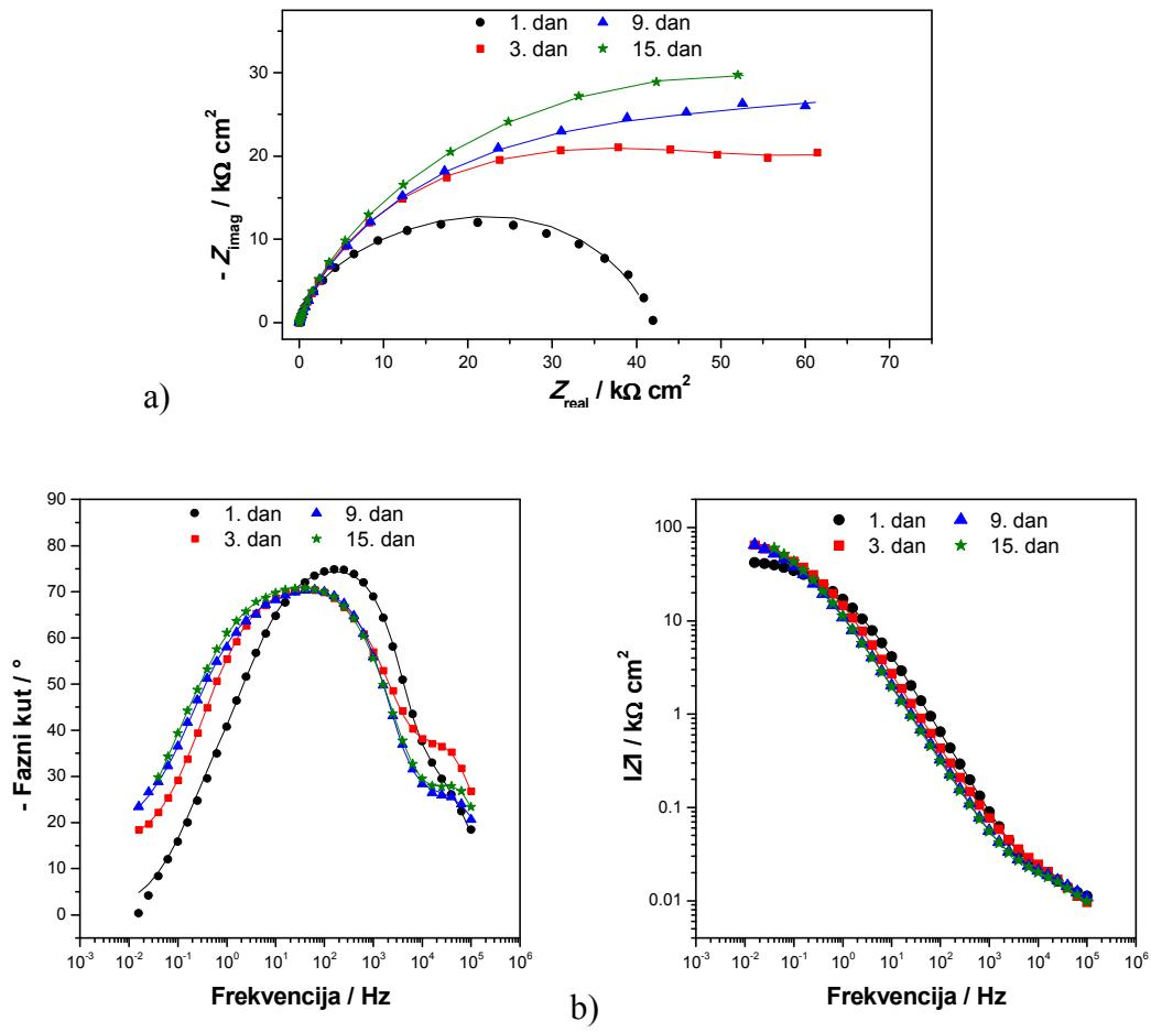
Slika 4.20. Impedancijske krivulje za uzorak A, a) Nyquistov prikaz, b) i c) Bodeov prikaz (simboli – eksperimentalni podaci, linije – rezultati dobiveni iz modela)
