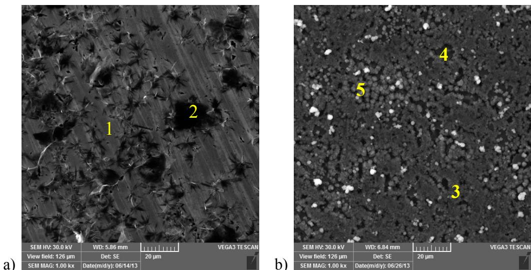
Slika 4.29. S1 uzorak prije i nakon 10 dana u NaCl – u
