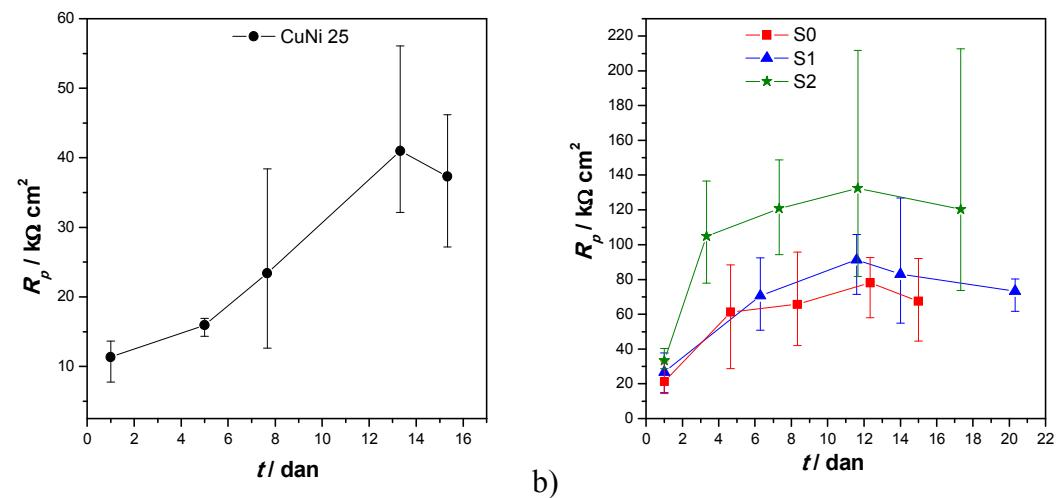
Slika 4.2. Ovisnost polarizacijskog otpora o vremenu dobivena polarizacijskim mjeranjima u 3% NaCl-u za a) netretirani uzorak i b) S0, S1 i S2 uzorke tretirane stearinskom kiselinom
