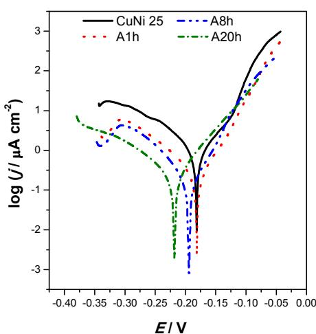
Slika 4.7. Polarizacijske krivulje dobivene ispitivanjem utjecaja vremena adsorpcije
