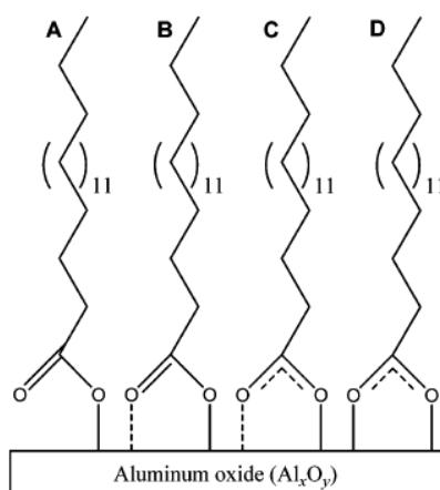
Slika 2.10. Mono- i bidentatni način vezanja karboksilne kiseline na površinu Al oksida<sup>66</sup>
