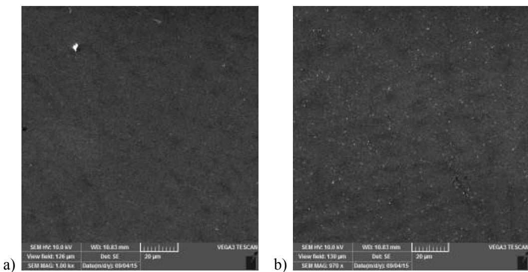
Slika 4.85. HDPA 0,001 povećanje 1000x, a) prije i b) nakon izlaganja NaCl-u
