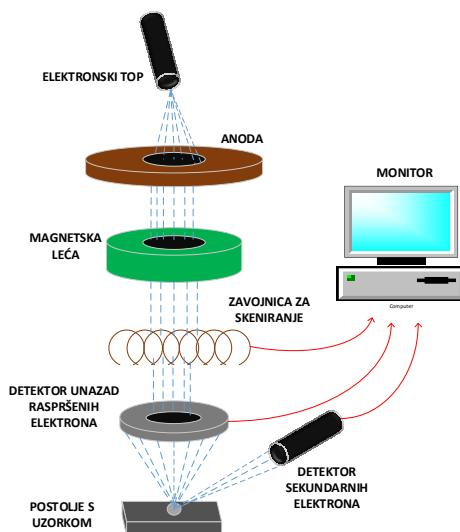
Slika 3.22. Shematski prikaz dijelova pretražnog elektronskog mikroskopa<sup>104</sup>
