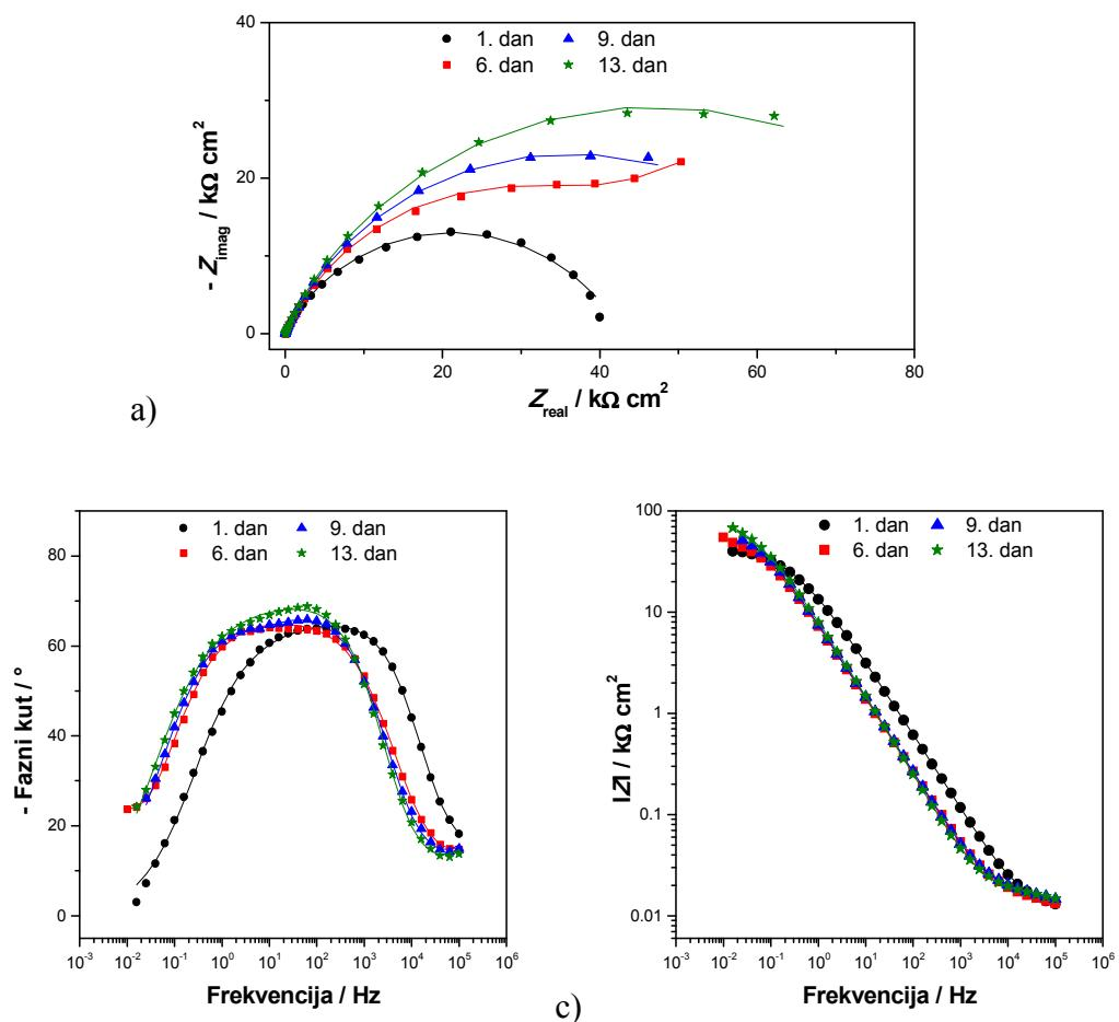
Slika 4.21. Impedancijske krivulje za uzorak A1h, a) Nyquistov prikaz, b) i c) Bodeov prikaz (simboli – eksperimentalni podaci, linije – rezultati dobiveni iz modela)
