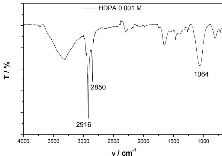
Slika 4.83. FTIR-ATR spektar za uzorak tretiran HDPA 0,001 M
