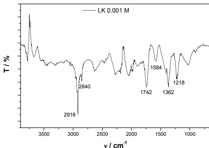
Slika 4.67. FTIR-ATR spektar uzorka tretiranog LK 0,001 M
