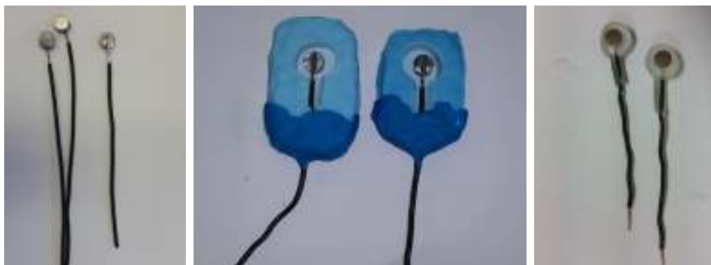
Slika 3.1. Izrada radnih elektroda – zalijeivanje CuNi elektroda u epoksidnu smolu
