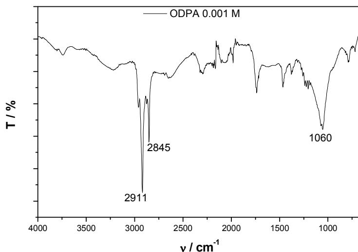
Slika 4.82. FTIR-ATR spektar za uzorak tretiran ODPA 0,001 M
