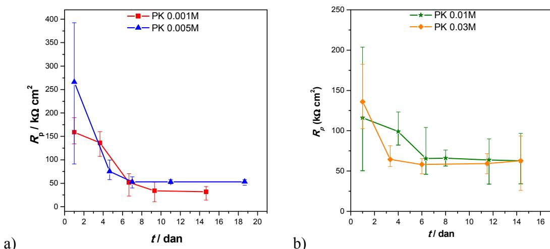
Slika 4.41. Ovisnost polarizacijskog otpora o vremenu za palmitinsku kiselinu, dobivena polarizacijskim mjeranjima izlaganjem 3% NaCl-u
