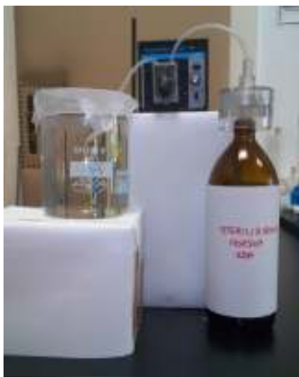
Slika 3.5. Postupak membranske filtracije prirodne morske vode
