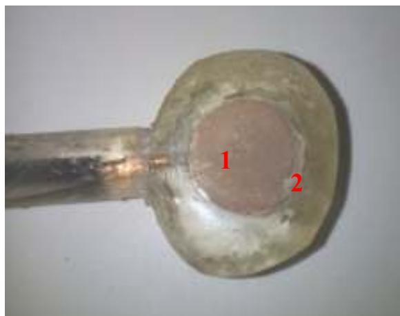
Slika 4.95. Netretirani CuNi 25 uzorak nakon izlaganja 43 dana prirodnoj morskoj vodi, 1 – središnji dio uzorka, 2 – rubni dio uzorka
