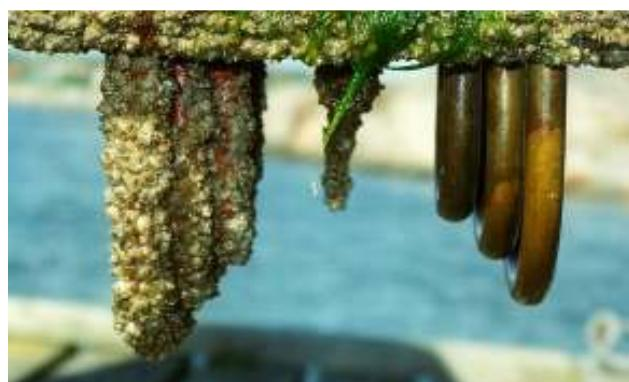
*Slika 2.6. Usporedba cijevi zaštićenih premazom (lijeva strana) i cijevi izrađenih od legura bakra i nikla<sup>18</sup>*
