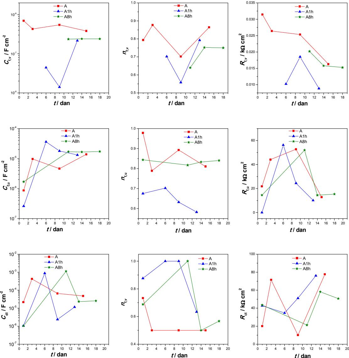
Slika 4.23. Ovisnost impedancijskih parametara o vremenu za A, A1h i A8h uzorke
