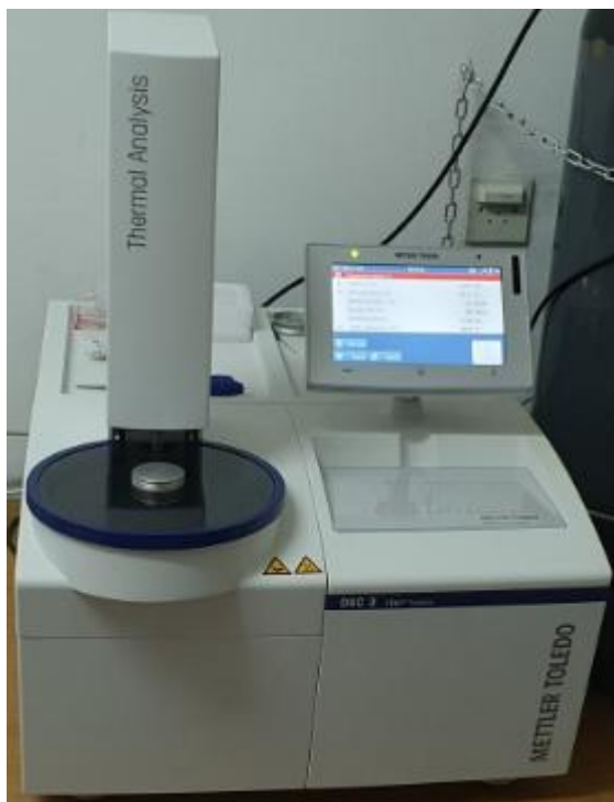
Slika 25. Prikaz DSC uređaja Mettler Toledo, marke DSC 3+
