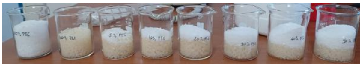
Slika 19. Pripremljene odvage polimera za umješavanje na Brabender gnjetilici (s lijeva na desno : 100 % PEG, 100% PLA, PLA/ 5% PEG, PLA/ 10% PEG, PLA/ 20% PEG, PLA/ 30% PEG, PLA/ 40% PEG, i PLA/ 50% PEG)
