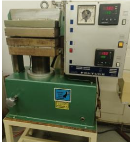
Slika 23. Hidraulična preša Fontune Holland SRB 140
