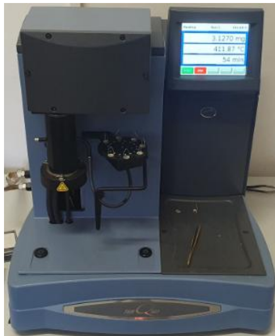
Slika 27. Uređaj za termogravimetrijsku analizu, TA Instruments Q500
