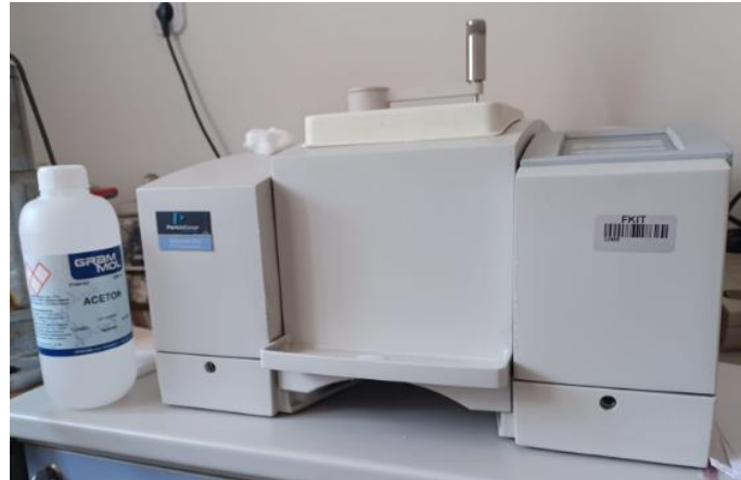
Slika 26. FTIR uređaj PerkinElmer Spectrum One
