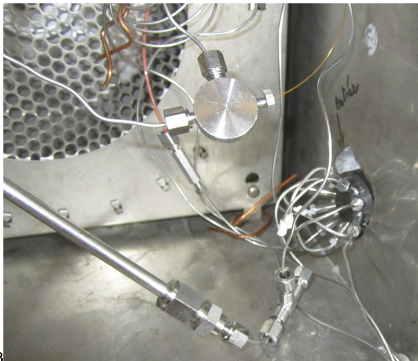
Slika 21. Termostatirajuća pećnica HP5890, vidljivi svi dijelovi sustava - A, uvećanje dijela sustava za prijenos analita – vidljiv ventil s 10 ulaza B
