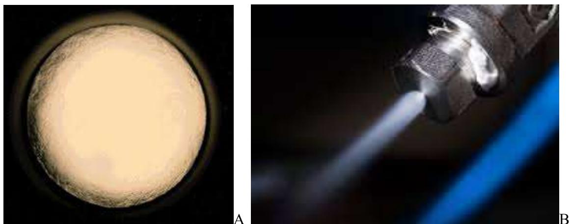
**Slika 4.** Superkritični CO<sub>2</sub> u pred ekstrakcijskoj komori - A, pri dekompresiji - B
