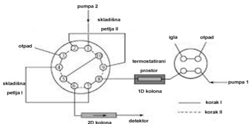
**Slika 13.** Shematski prikaz 2D-LC-sustava, istaknute su skladišne petlje
