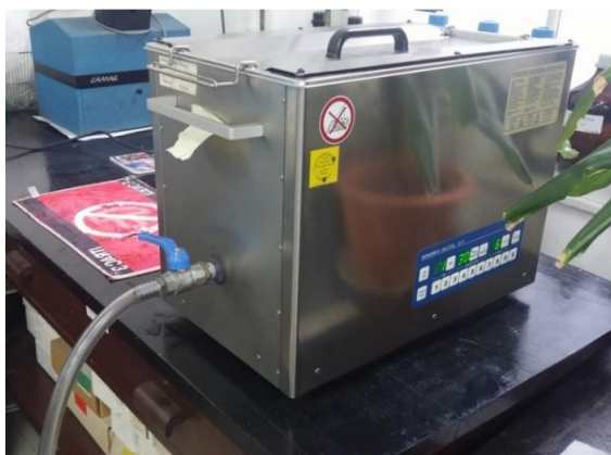
Slika 21. Ultrazvučna kupelj Bandelin Sonorex Digital 10 P i nosač s uzorcima.
