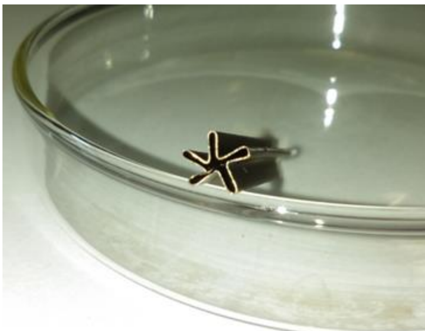
Slika 3.3. Metalni monolitni katalizator
