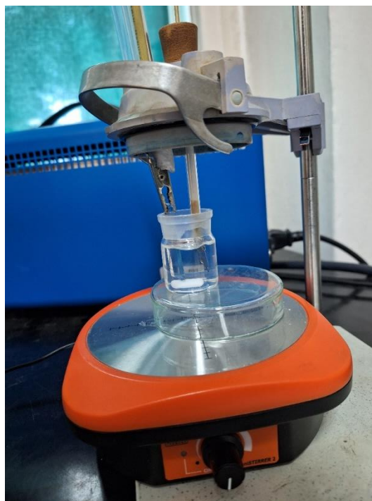
Slika 3.8. Dvoelektrodna elektrokemijska ćelija za fotoelektrokemijski proces razgradnje farmaceutika amoksicilina i magnetna miješalica Labware uniSTIRRER
