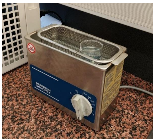
Slika 3.2. Čišćenje FTO staklenih supstrata u ultrazvučnoj kupelji Bandelin SONOREX SUPER RK 31
