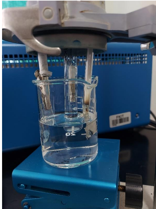
Slika 3.5. Troelektrodna elektrokemijska ćelija za elektrokemijsku sintezu \text{WO}_3 fotokatalizatora
