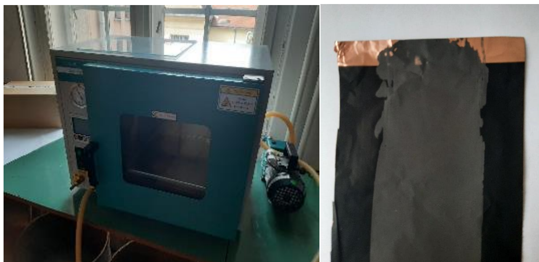
Slika 3.2. a) Vakuumski sušionik – EV-50 (Raypa, Španjolska), b) sloj osušene paste na bakrenoj foliji za dobivanje elektroda
