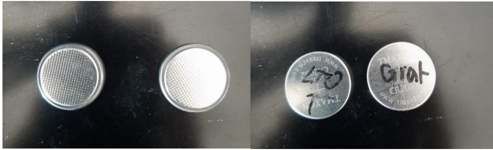
Slika 3.4. Dobiveni dugmasti galvanski članci s gornje (lijevo) i donje (desno) strane
