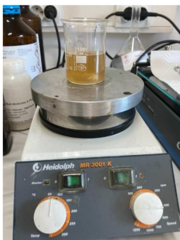
Slika 20. Priprava prevalake od hitozana na magnetskoj mješalici
