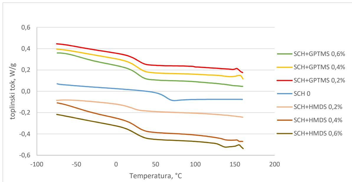
Slika 35. Usporedni DSC termogrami 2. ciklusa zagrijavanja
