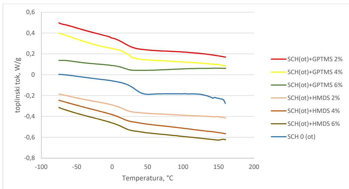
Slika 36. Usporedni DSC termogrami 2. ciklusa zagrijavanja
