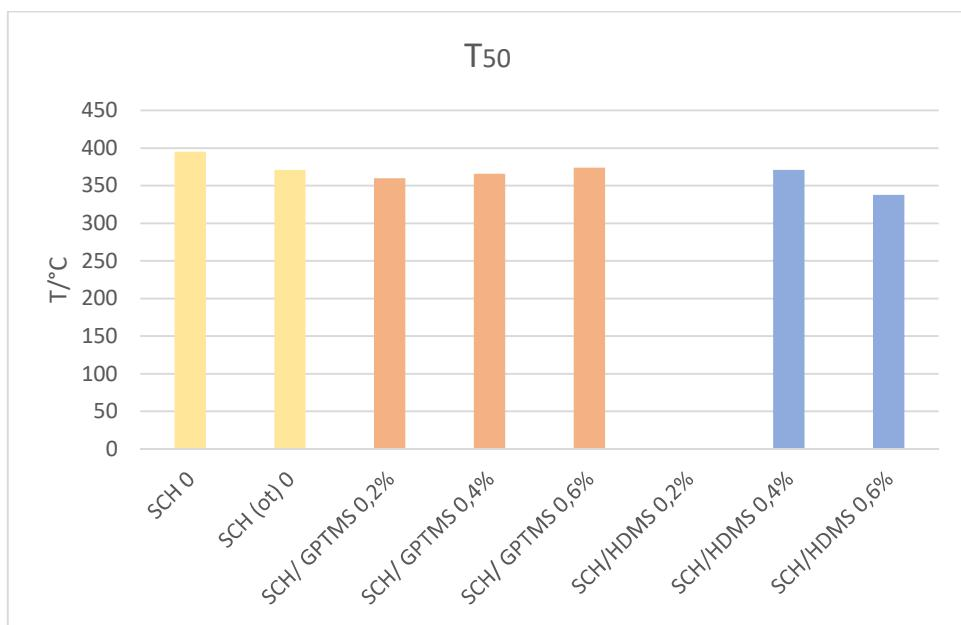
*Slika 42.* Grafički prikaz temperatura  $T_{50}$  ishodnog šelaka SCH 0, otopine šelaka i prevlaka šelaka sa silanima SCH/GPTMS i SCH/HDMS
