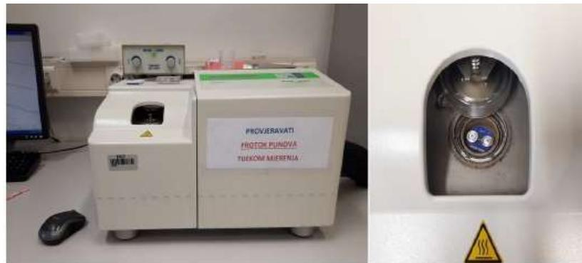
Slika 25. Diferencijalni pretražni kalorimetar, *Mettler Toledo DSC 823e*.
