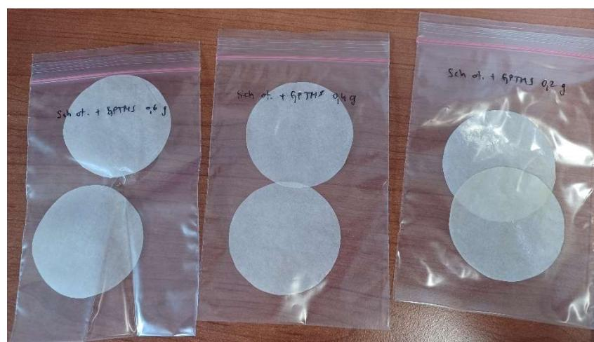
Slika 29. Epruvete za ispitivanja propusnosti vodene pare.
