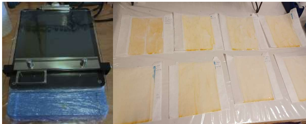
Slika 24. Izvlačenje filмова na automatskom izvlakivaču.
