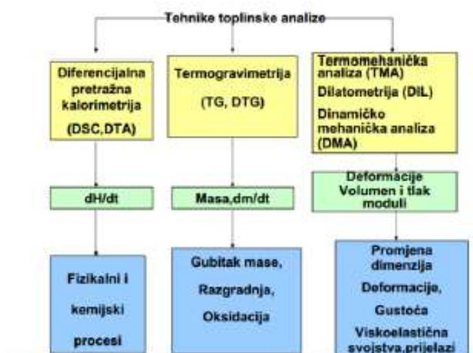
Slika 11. Shematski prikaz podjele tehnika toplinske analize. (24)
