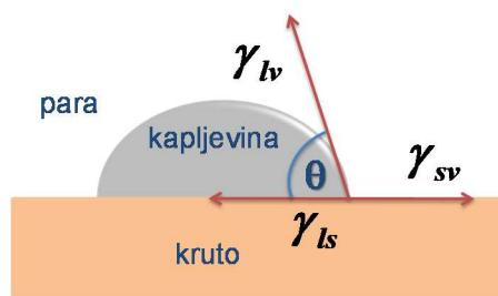
*Slika 18.* Prikaz kontaktnog kuta kapljevine na krutoj površini i komponenata slobodne površinske energije (40)
