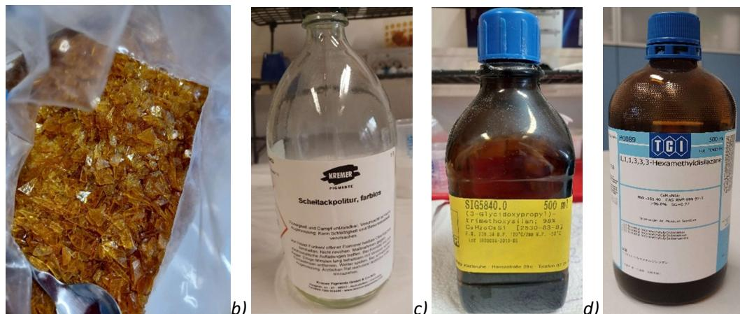
Slika 20. Komponente za pripravu prevlaka a) kruti šelak, b) komercijalna otopina šelaka, c) GPTMS-silan i d) HMDS-silan).
