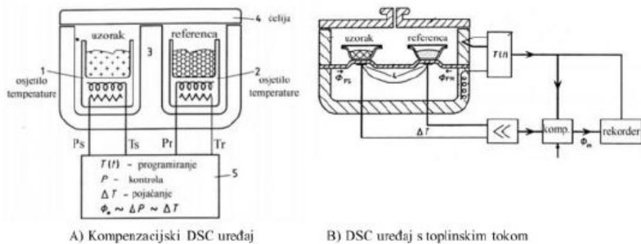
Slika 12. Shematski prikaz dva osnovna tipa DSC uređaja. (28)
