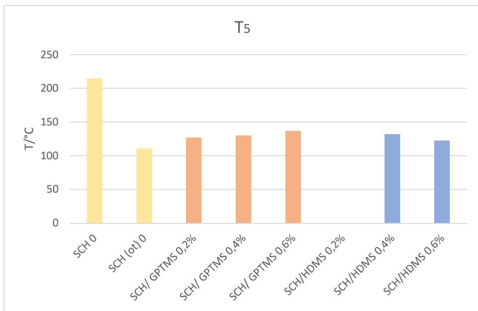
*Slika 41.* Grafički prikaz temperatura  $T_5$  ishodnog šelaka SCH 0, otopine šelaka i prevlaka šelaka sa silanima SCH/GPTMS i SCH/HDMS
