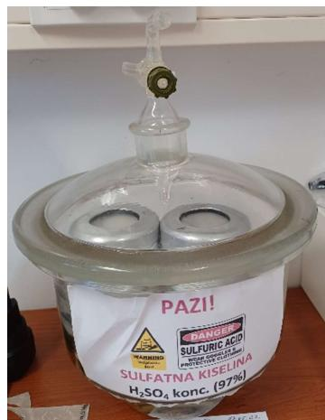
Slika 28. Herfeld-ov uređaj za određivanje propusnosti vodene pare.
