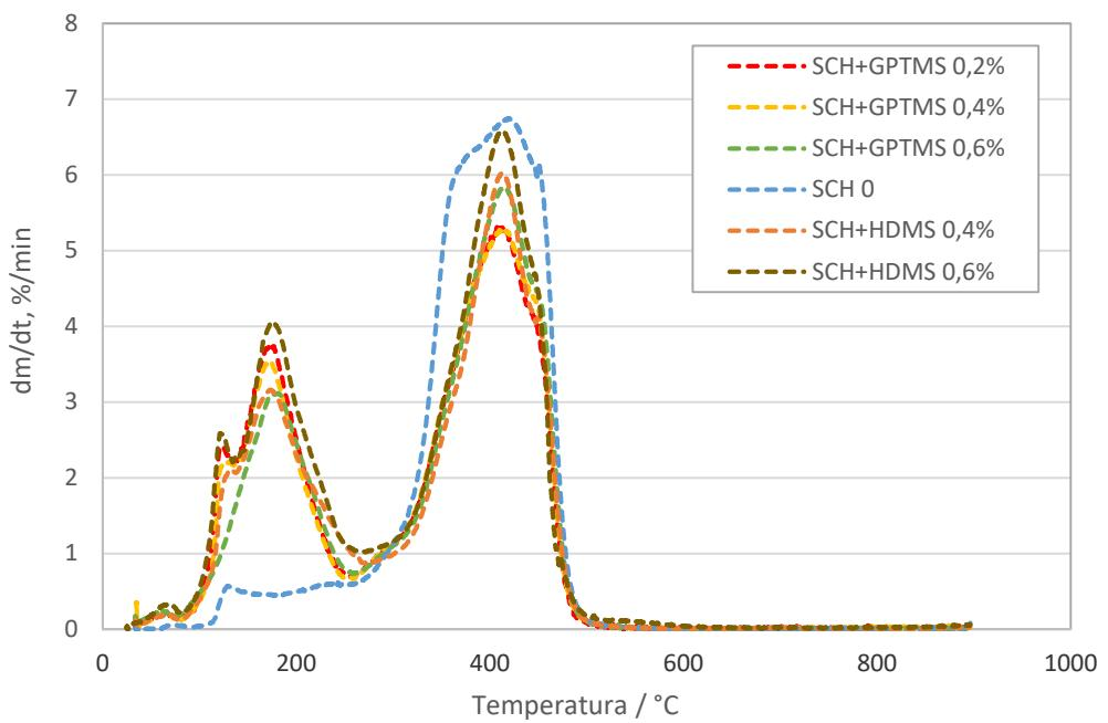
Slika 40. DTG krivulje mješavina šelak prevlaka SCH/GPTMS i SCH/HMDS usporedno sa SCH 0
