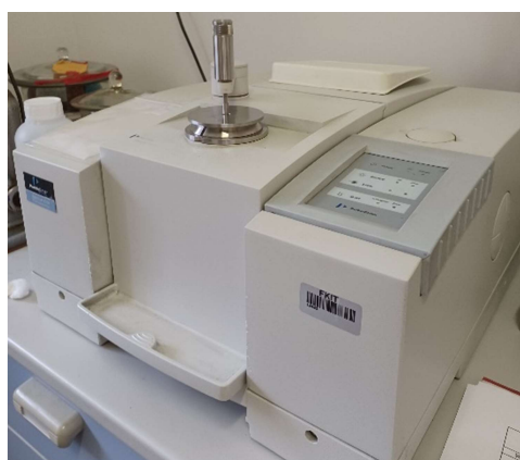
Slika 27. Perkin Elmer Spectrum One Spectrometer s ATR sustavom.
