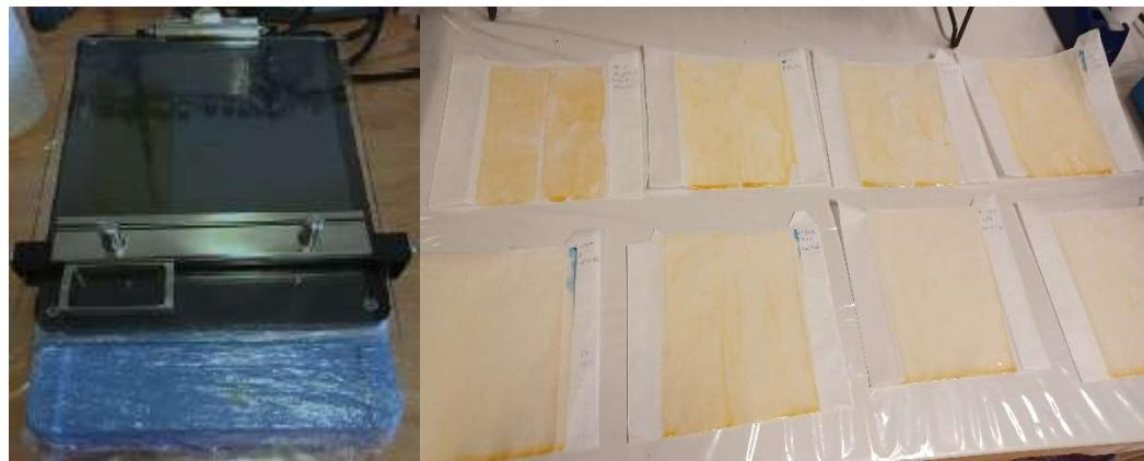
Slika 24. Izvlačenje filmova na automatskom izvlakivaču.
