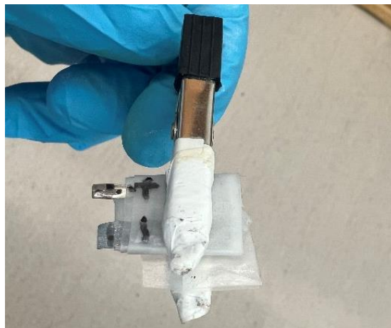
Slika 3.10. a) GO papiri \approx 1 \text{ cm}^2 te niklena i cinkova elektroda i b) sastavljena Zn//rGO/V 2 O 5 baterija
