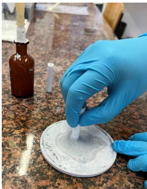
Slika 3.1. Poliranje GC elektrode s \text{Al}_2\text{O}_3 lampom
