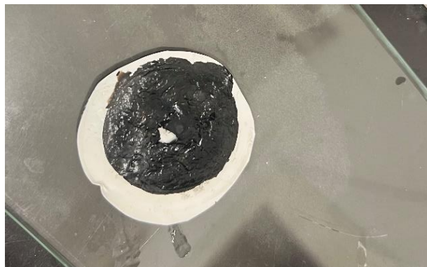
Slika 3.8.rGO papir dobiven nakon elektrokemijske redukcije Slika 3.9.Aparatura za redukciju GO papira
