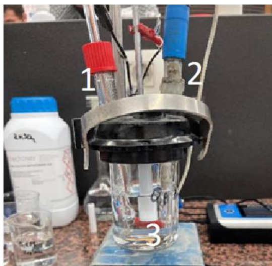
Slika 3.4. Troelektroadni sustav: 1-protuelektroda 2-referentna, 3-radna
