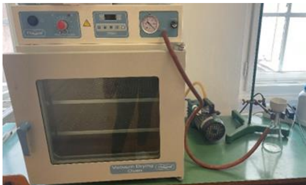
Slika 3.7. Aparatura za pripremu GO papira
