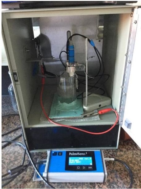
Slika 4. Ispitivanje viskoelastične prevlake metodom elektrokemijske impedancijske spektroskopije a) prema normi HRN EN ISO 16773 i b) impedancijski spektri. [4]
