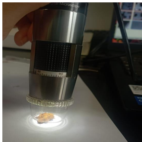
Slika 24. Prikaz upotrebe digitalnog mikroskopa na korozivskim produktima.
