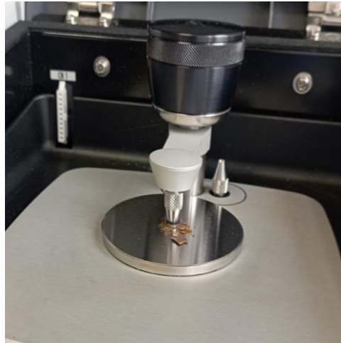
Slika 23. Prikaz ATR-FTIR mjerenja na uzorcima korozivskih produkata.
