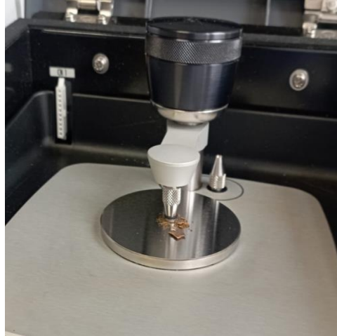
Slika 23. Prikaz ATR-FTIR mjerenja na uzorcima korozivskih produkata.
