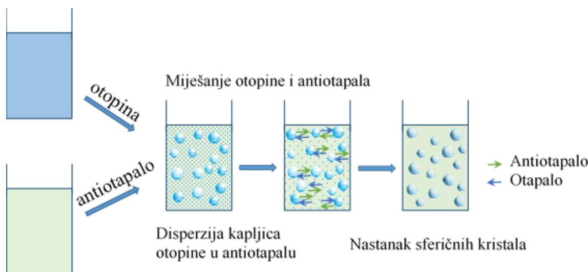
Slika 4. Shematski prikaz QESD metode.<sup>10</sup>
