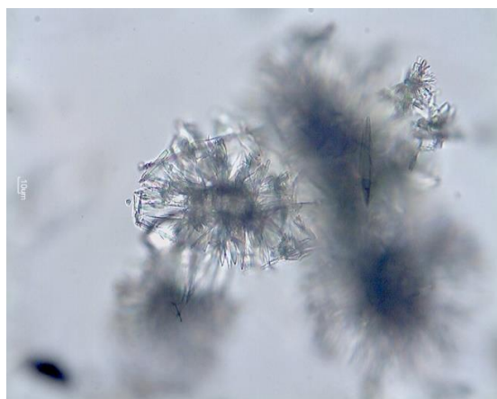
Slika 20. Kristali dobiveni sferičnom aglomeracijom ceritiniba u sustavu aceton – voda – heksan (lijevo) i aceton – voda – toluen (desno) pri uvećanju 100x i aceton – voda – heptan (dolje) pri uvećanju 400x.
