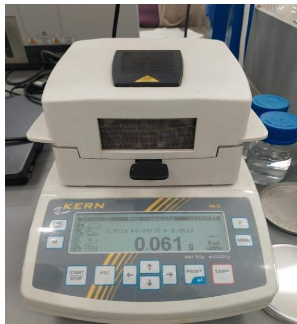
*Slika 7. Analizator vlage Kern & Sohn.*
