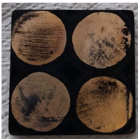
Slika 4.60. Ispitivanje prionjivosti premaza na patiniranoj površini bronce.
