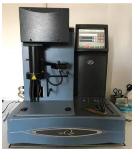
Slika 3.25. TGA analizator Q500.
