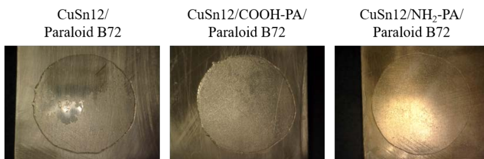
Slika 4.45. Slike uzoraka nakon ispitivanja prionjivosti premaza vlačnom metodom.
