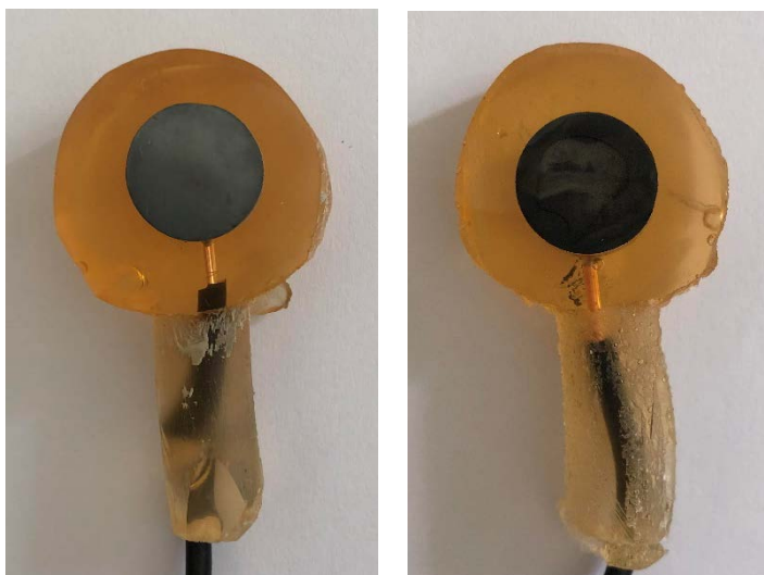
Slika 4.55. Patina prije (lijevo) i nakon (desno) uranjanja u etanolnu otopinu COOH-PA.
