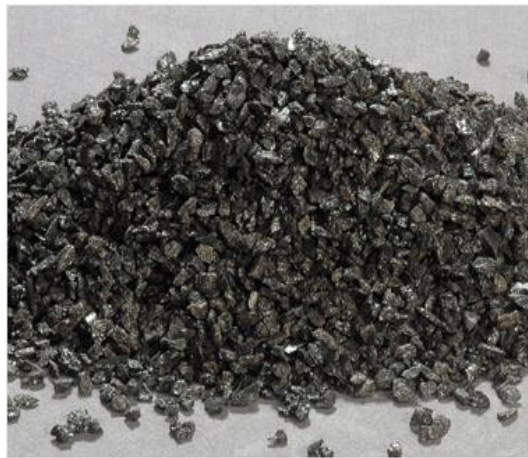
Slika 4. Smeđi taljeni aluminijev oksid tvrtke Orient abrasives Ltd
