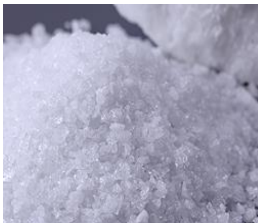
Slika 5. Bijeli taljeni aluminijev oksid tvrtke Alteo
