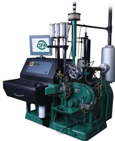
Slika 1. CFR motor za određivanje cetanskog broja prema normi ASTM D909
