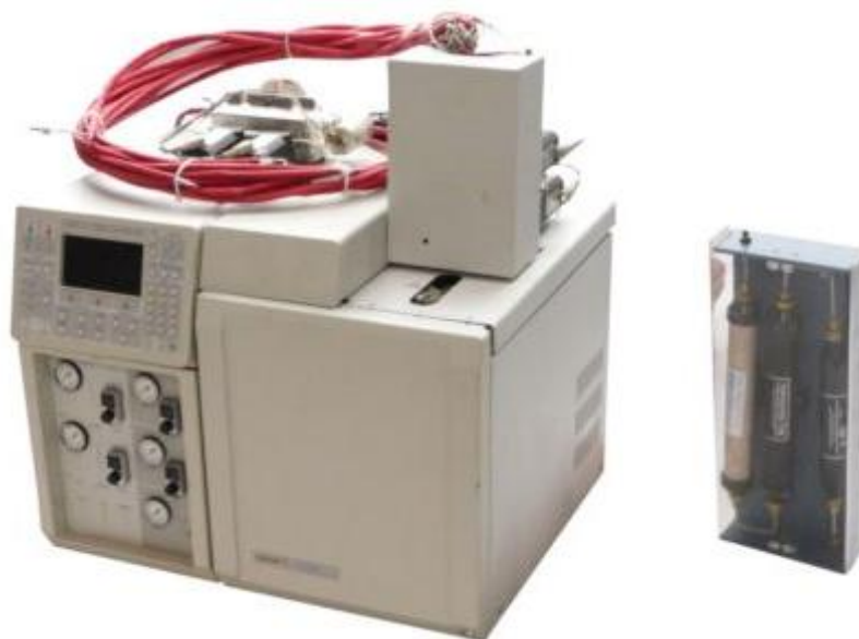
Slika 14. Plinski kromatograf Varian CP 3800
