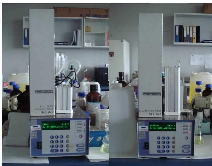
Slika 11. Lijevo – uređaj za određivanje točke filtrabilnosti (Herzog HCP 842), desno – uređaj za određivanje točke tečenja i zamućenja (Herzog HCP 852)
