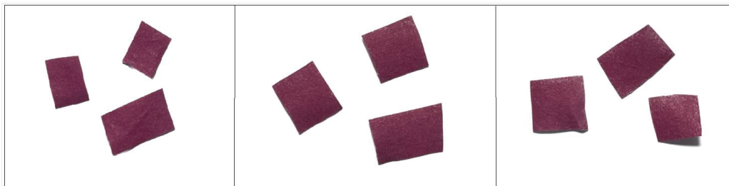
Slika 3.9. Magenta otisci dobiveni digitalnom tehnikom tiska na papirima s 10% pulpe slame žitarica, redom: 1NP, 1NJ, 1NTR
