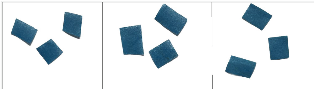
Slika 3.8. Cijan otisci dobiveni digitalnom tehnikom tiska na papirima s 10% pulpe slame žitarica, redom: 1NP, 1NJ, 1NTR
