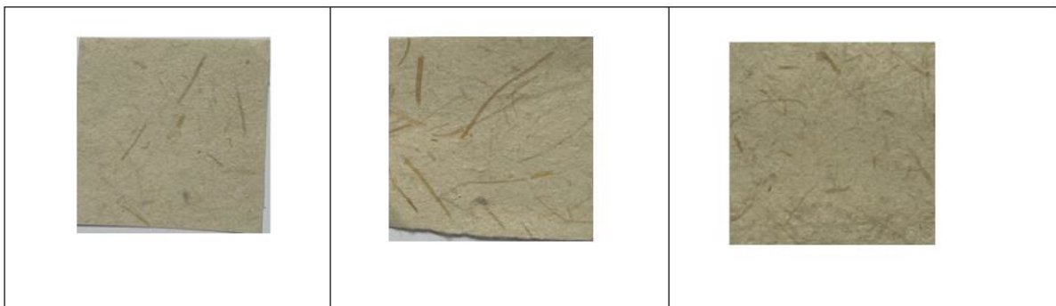
Slika 3.4. Neotisnuti laboratorijski uzorci papira s pulpom slame ječma, redom: 1NJ, 2NJ, 3NJ.
