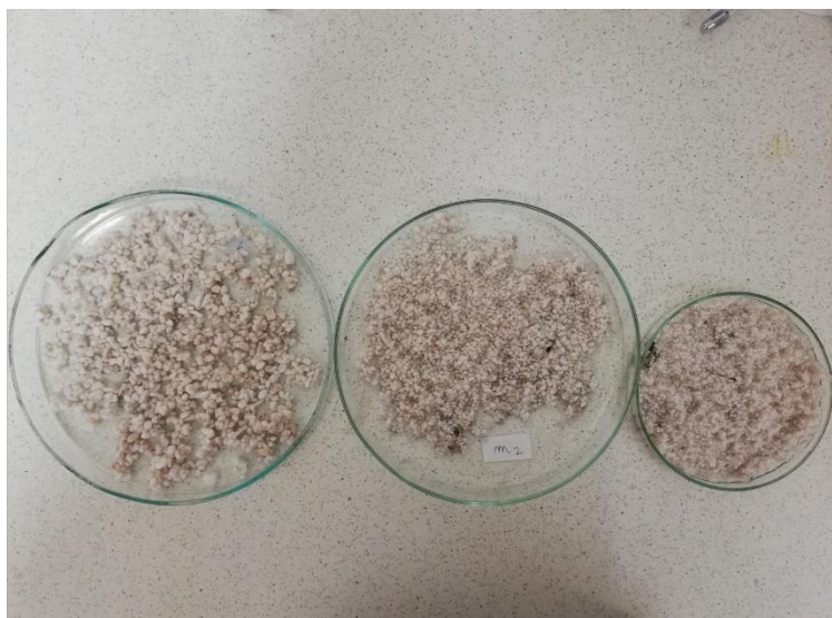
Slika 9. Frakcije perlita korištene za pripremu heterogenog fotokatalizatora
