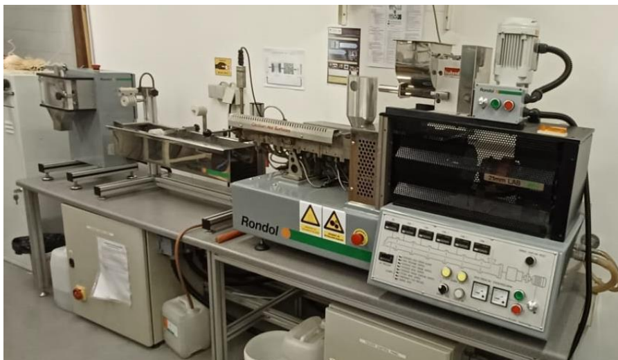
Slika 3.1. Dvopužni laboratorijski ekstruder, Randol Bench Top 21
