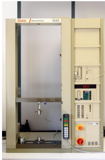
Slika 3.5. Mehanička kidalica Zwick UTM 1445
