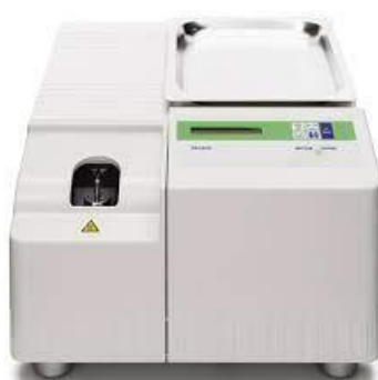
Slika 3.4. Diferencijalni pretražni kalorimetar, Mettler Toledo DSC 823e
