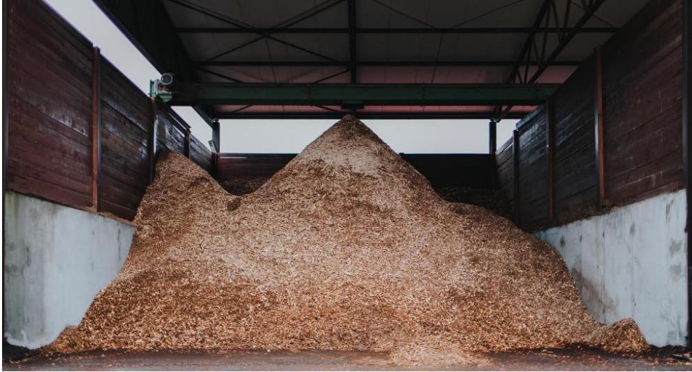
Slika 11. Sušenje usitnjene biomase na prirodnom propuhu.
