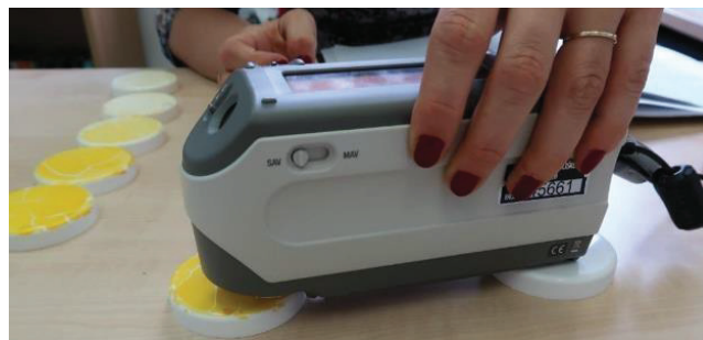
Slika 26. Uređaj Konica Minolta spektrometar CM-2600d [54]
