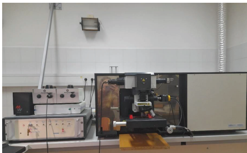
Slika 24. Uređaj LabRAM Horiba HR Raman HR800
