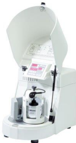
Slika 11. Fotografija planetarnog kugličnog mlina Pulversitte 6 (Fritsch GmbH, Weimar, Savezna Republika Njemačka)
