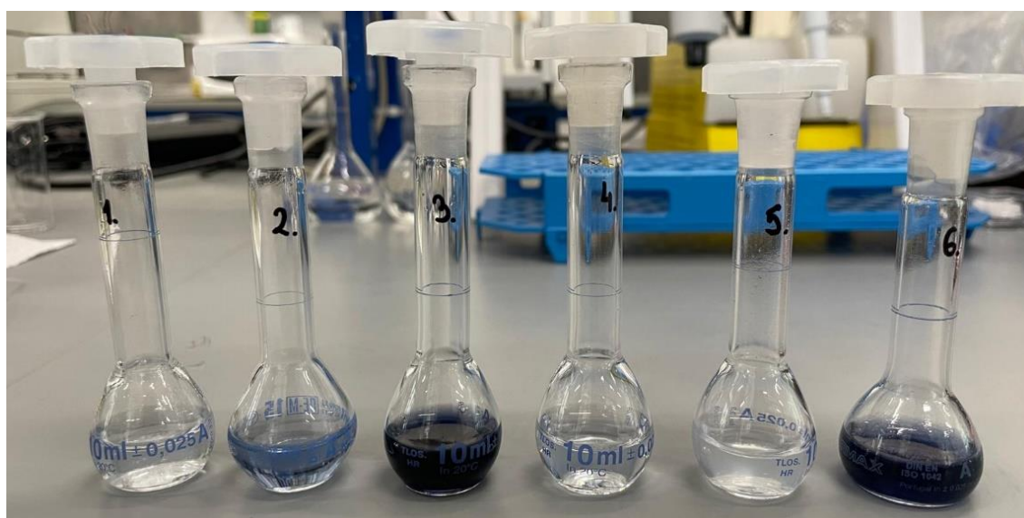
Slika 41. Obojenje uslijed pojave molidbenovih i volframovih oksida – limun (1), lovor (2), klinčić (3), m. oraščić (4), z. anis (5), origano (6)
