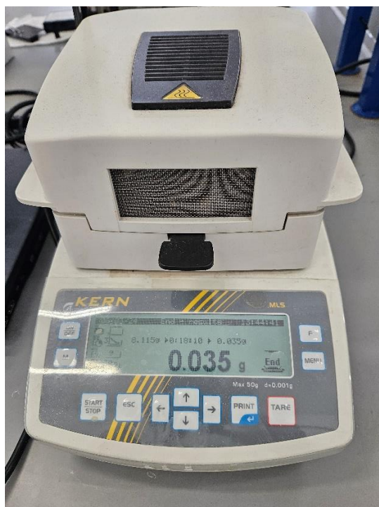
Slika 20. Prikaz korištenog infracrvenog sušionika.
