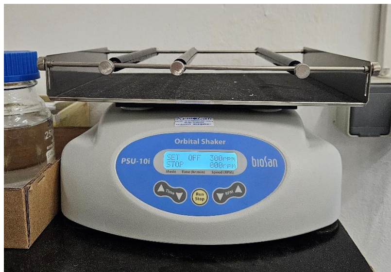
Slika 19. Prikaz tresilice za provođenje ekstrakcije.
