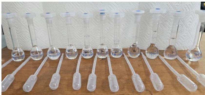
Slika 23. Prikaz odmjernih tikvica za određivanje indeksa loma.
