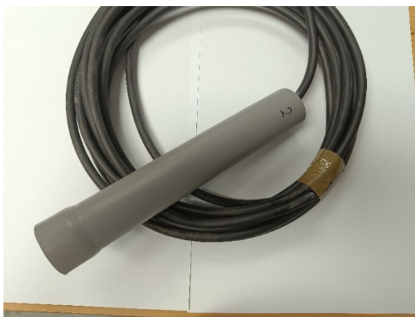
Slika 22. (desno) Prvi primjer industrijski korištenog IR-free kupona – referentna elektroda
