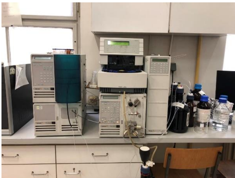
Slika 13. Uređaj za analizu tekućinskom kromatografijom visoke djelotvornosti (HPLC uređaj)
