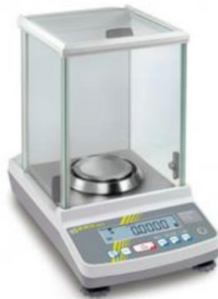
Slika 22. Fotografija analitičke vage KERN ALJ 220-4NM (KERN, Balingem, SR Njemačka)
