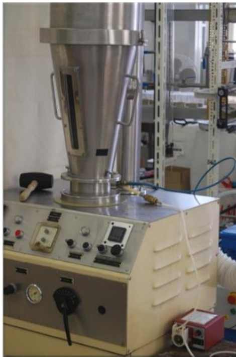
Slika 19. Fotografija granulatora s fluidiziranim slojem Uni-Glatt (Glatt GmbH, Binzen, SR Njemačka)
