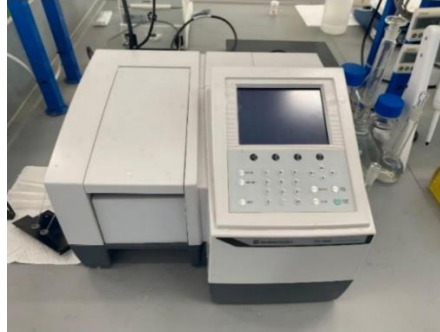
Slika 23. Fotografija spektrofotometra UV-1280 (Shimadzu, Kyoto, Japan)
