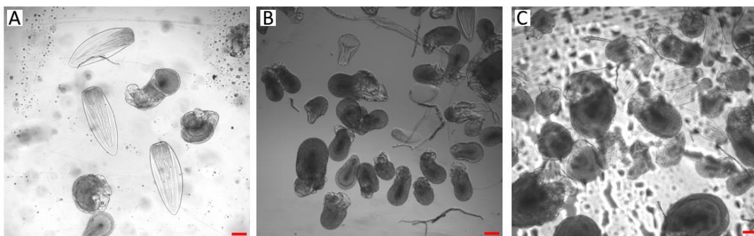
Slika 17. Mikrografije CHT-Cu mikrogelova nastalih (A) uranjanjem mikroreaktora u medij za neutralizaciju uz brzine protoka kontinuirane i dispergirane faze od 100:10 \text{ mL h}^{-1} , odnosno primjenom mikroreaktora s obrađenom površinom (teflonska obloga) uz omjer brzina protoka uljne i vodene faze od (B) 100:10 \text{ mL h}^{-1} , i (C) 200:20 \text{ mL h}^{-1} . Uvećanje je 4\times , a skala predstavlja 200 \mu\text{m} .
