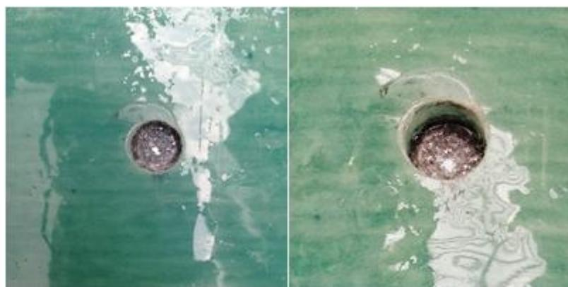
Slika 4.9. Izgled oštećenja sustava S5 promjera 6,5 mm prije i nakon izlaganja NaCl - u
