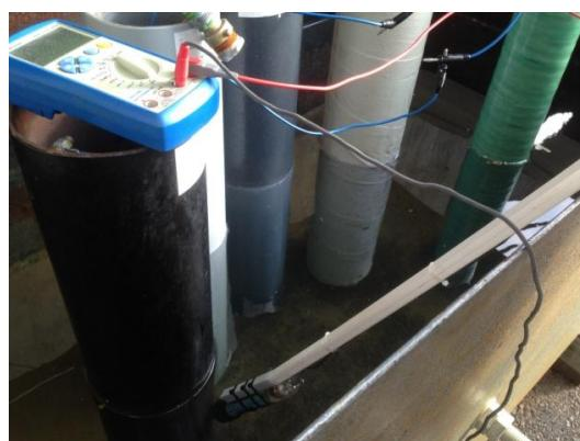
Slika 3.9. Mjerenje potencijala sustava pomoću Zn elektrode
