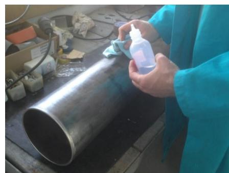
Slika 3.3. Odmašćivanje površine uzorka
