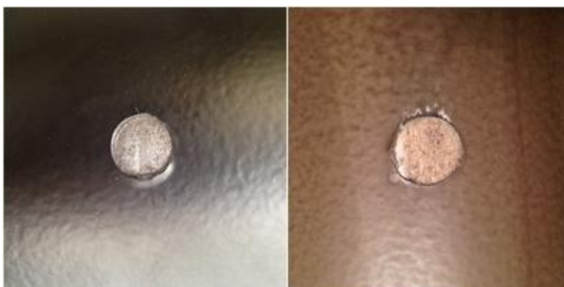
Slika 4.2. Izgled oštećenja sustava S1 promjera 13 mm prije i nakon izlaganja NaCl – u
