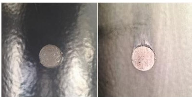
Slika 4.6. Izgled oštećenja sustava S3 promjera 13 mm prije i nakon izlaganja NaCl – u
