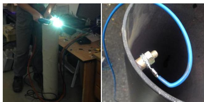
Slika 3.6. Zavarivanje kablova na uzorke
