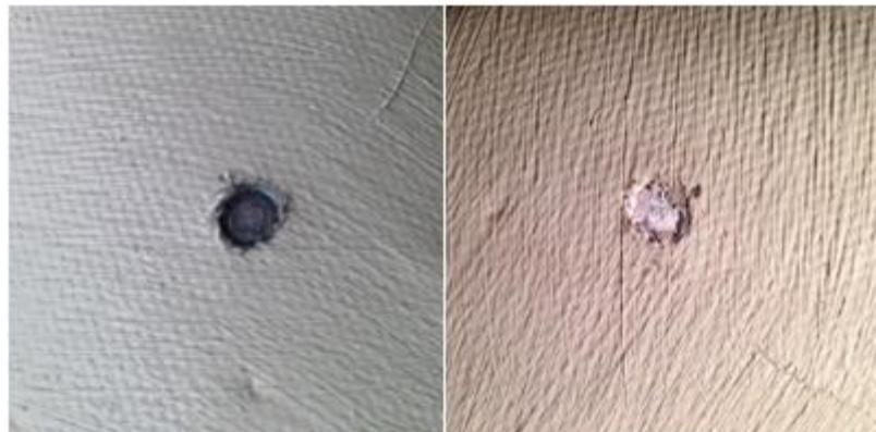
Slika 4.7. Izgled oštećenja sustava S4 promjera 6,5 mm prije i nakon izlaganja NaCl – u
