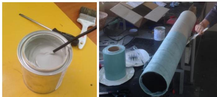
Slika 3.5. Završni premaz i apliciranje na prevlaku
