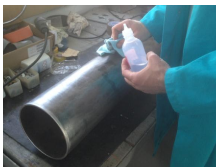
Slika 3.3. Odmaščivanje površine uzoraka
