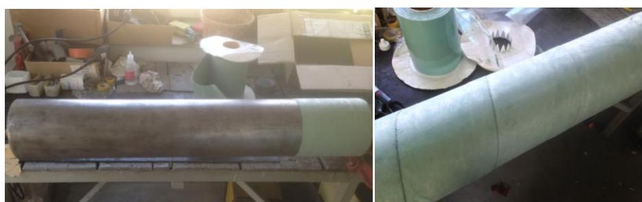
Slika 3.4. Postupak nanošenja prevlake
