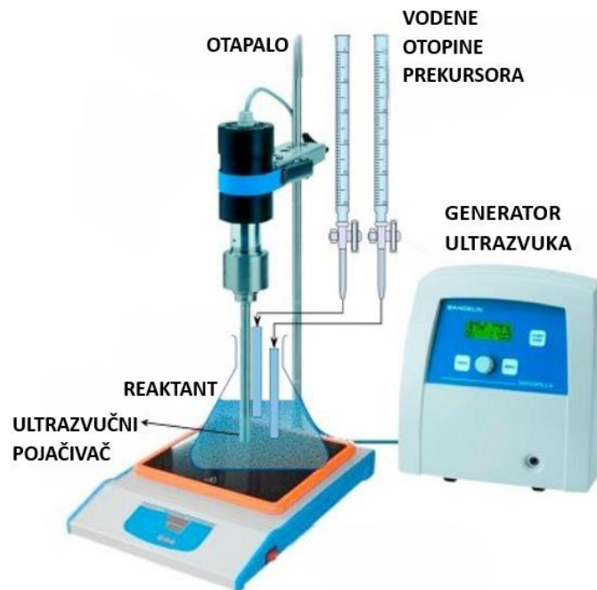
SLIKA 4. Prikaz aparature za sintezu visoko-entropijskih oksida sutaloženjem [7]
