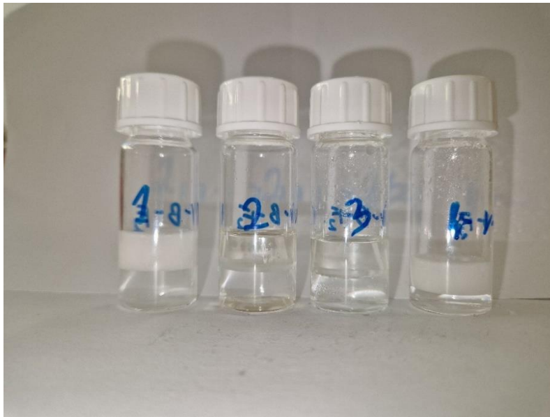
Slika 12. Pseudotrokomponentni sustavi voda – butanol – FABE 2
