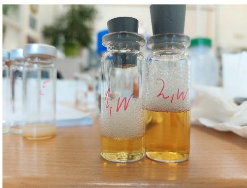
Slika 21. Rezultat miješanja osušenog sirovog glicerola iz tikvica 1. i 2. s vodom
