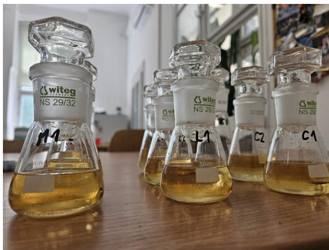
Slika 16. Prikaz smjesa sirovog glicerola s hidrofilnim DES-ovima 5, 6 i 7
