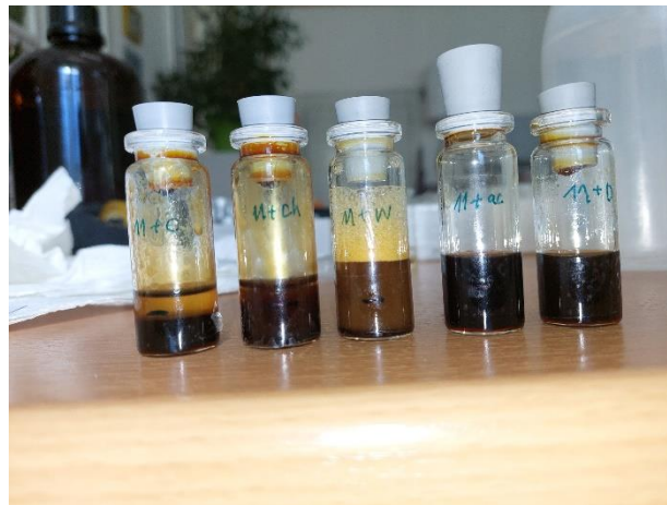
Slika 15. Bočice sa smjesama osušenog sirovog glicerola dobivenog iz kave i otapala različite prirode i polarnosti
