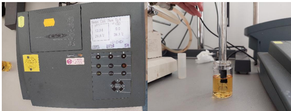
Slika 13. pH – metar i izvedba mjerenja pH
