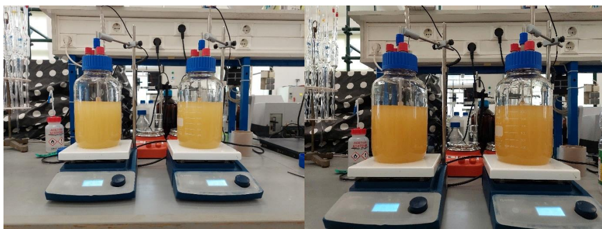
Slika 10. Izgled smjese nakon dodatka KOH i metanola
