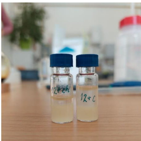
Slika 22. Rezultat miješanja uzorka 12. s heksanom i cikloheksanom
