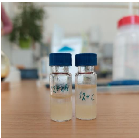
Slika 22. Rezultat miješanja uzorka 12. s heksanom i cikloheksanom
