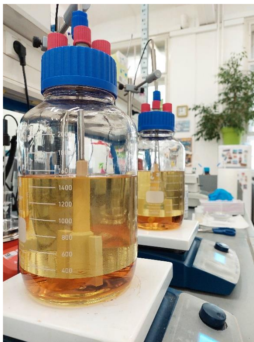
Slika 11. Smjesa nakon završetka procesa transesterifikacije
