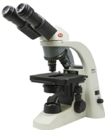
Slika 4. Svjetlosni mikroskop Motic BA200 .
