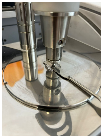
Slika 7.: a) FTIR spektrofotometar Vertex 70, Bruker , b) Primjer mjerenja spektra krutine.
