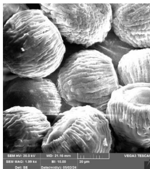
Slika 25. Mikrografija uzoraka nosača bioaktivnog stakla sa 0,5 mas./vol. % alginata i 10 mas./mas.% mikrosfera (BG-0,5ALG-10SF) i uzorka bioaktivnog stakla s 1 mas./vol.% alginata i 10 mas./mas.% mikrosfera (BG-1 ALG 10 SF).
