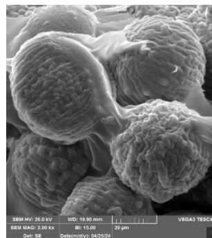
Slika 25. Mikrografija uzoraka nosača bioaktivnog stakla sa 0,5 mas./vol. % alginata i 10 mas./mas.% mikrosfera (BG-0,5ALG-10SF) i uzorka bioaktivnog stakla s 1 mas./vol.% alginata i 10 mas./mas.% mikrosfera (BG-1 ALG 10 SF).
