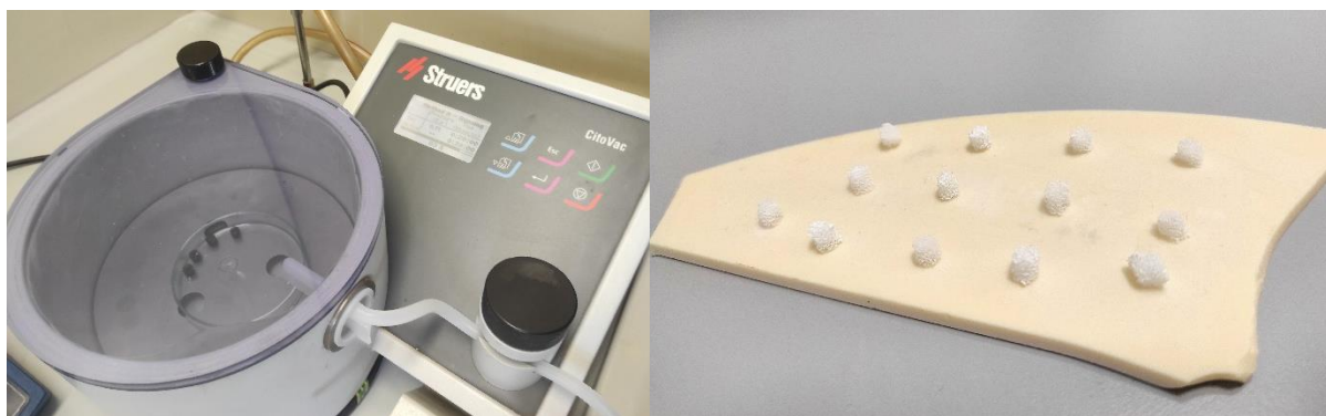
Slika 20. Vakuumiranje uzoraka, te prikaz uzoraka nakon sinteriranja.
