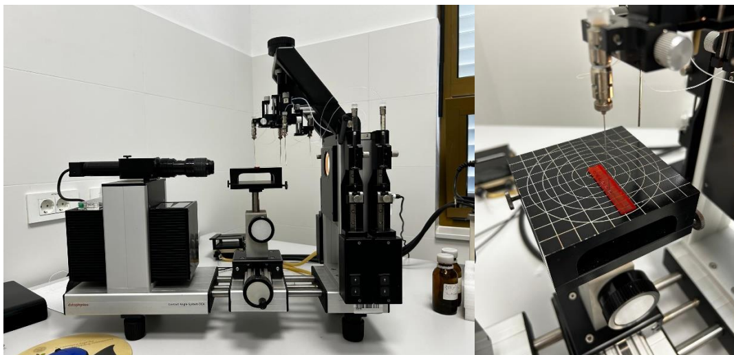
Slika 29. Mjerenje kontaktnog kuta na goniometru OCA 20 DataPhysics
