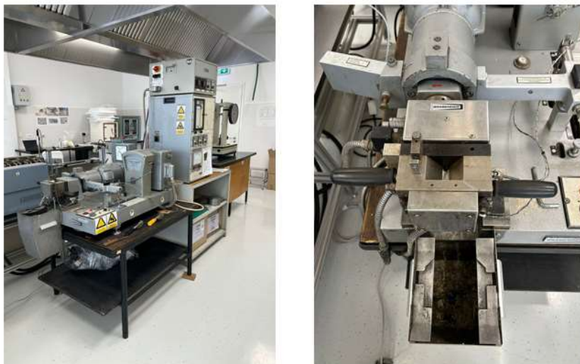
Slika 8. Brabender gnjetalica (lijevo) i komora gnjetalice s dva pužna valjka (desno)
