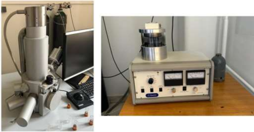
Slika 12. Pretražni elektronski mikroskop s EDX kamerom (lijevo) i napanjač uzoraka (desno)
