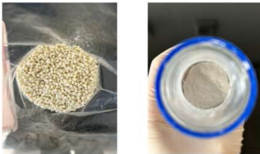
Slika 7. Polimerna matrica PHBV (lijevo) i punilo \text{TiO}_2 (desno)
