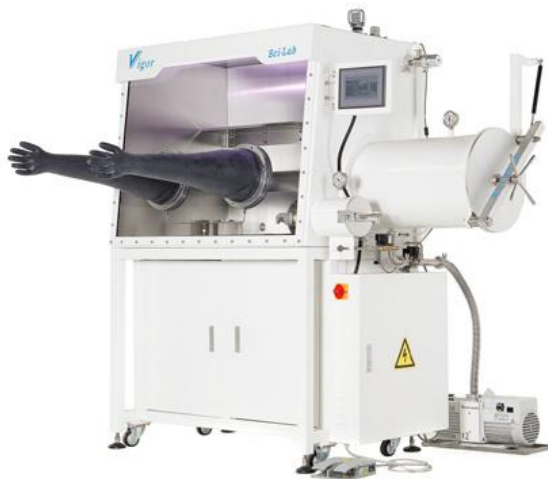
Slika 3.2. Glove box komora s atmosferom argona
