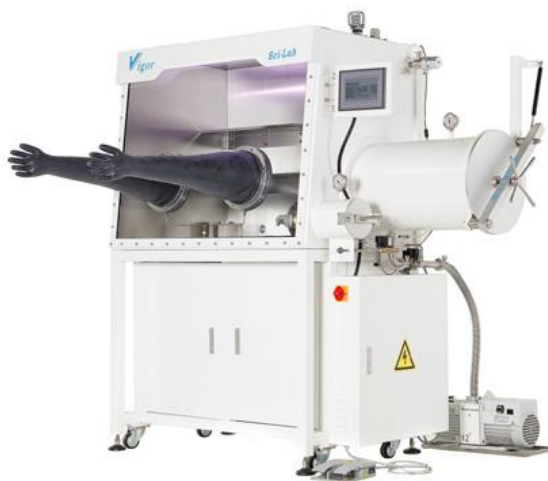
Slika 3.2. Glove box komora s atmosferom argona
