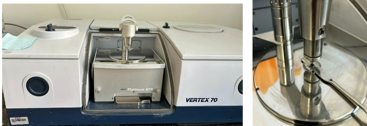
Slika 3.4. FTIR uređaj Vertex 70 i pripadajuća komora za postavljanje uzorka.
