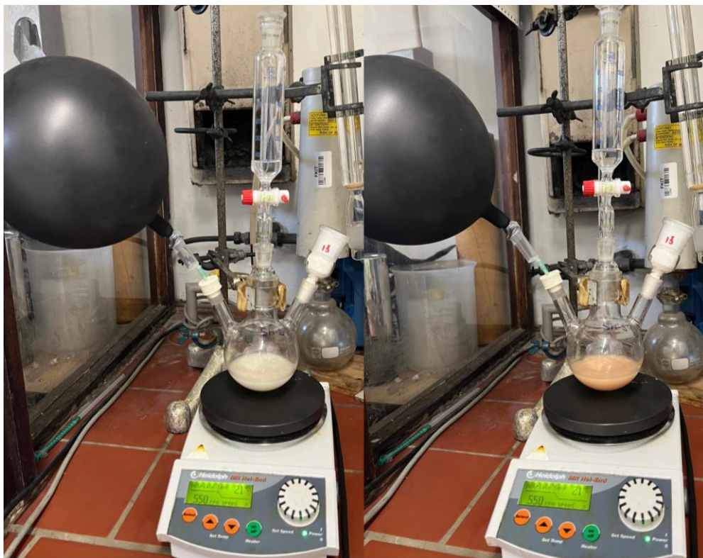
Slika 31. Prikaz aparature te reakcijske smjese prije (lijevo) i nakon dodatka aldehida (desno).
