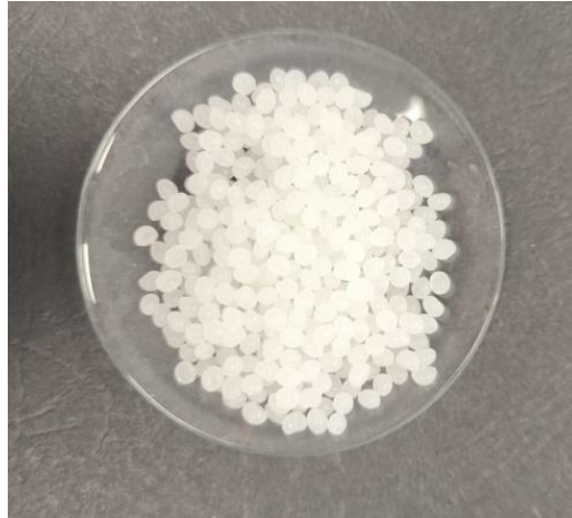
Slika 8. Polimerna matrica: PLA granule
