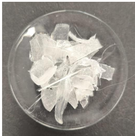
Slika 11. Kompozit pripravljen i narezan nakon zamješavanja u Brabender gnjetilici
